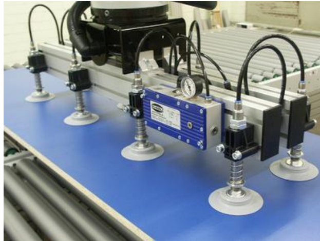
Obrázek 70. Manipulátor s podtlakovým efektoem [40]
