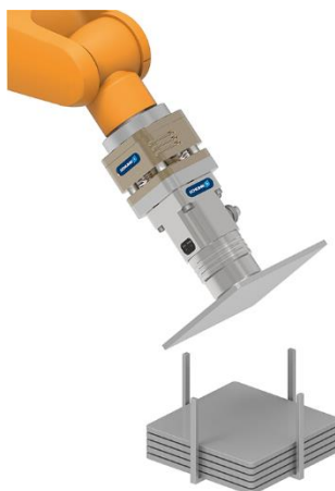
Obrázek 71. Manipulátor s magnetickým efektoem [39]
