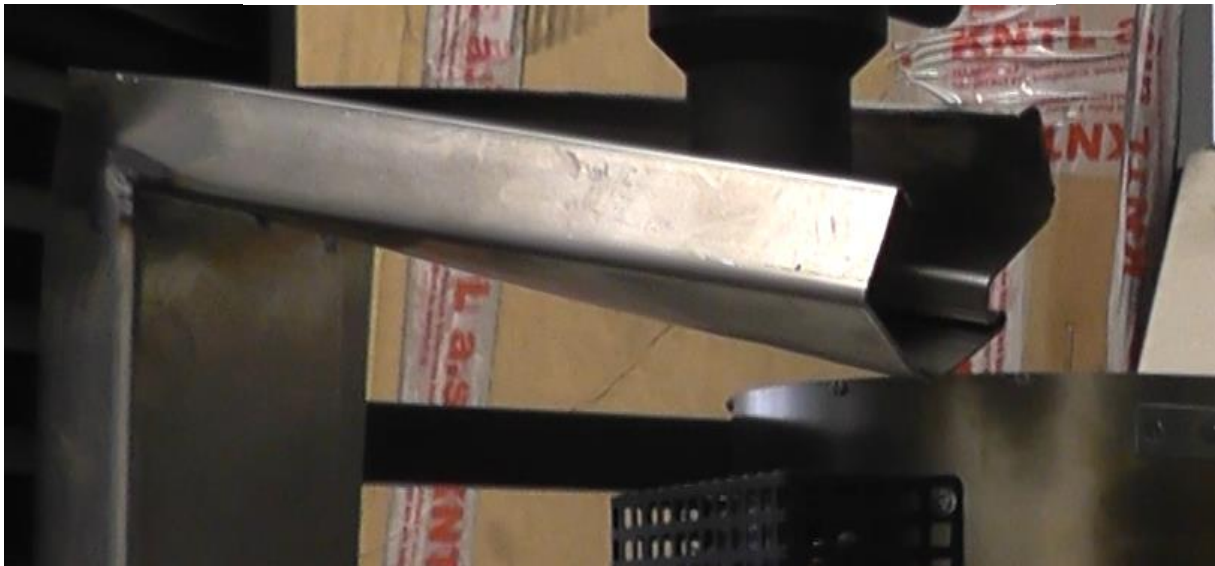
Obrázek 33 Skutečná deformace v místě působení síly svařeného spoje [-]
