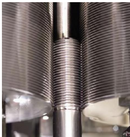
Obrázek 6 Profilové válcování vnějšího závitu [12]
