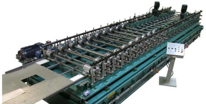
Obrázek 13 Duplexní profilovací stroj se spojeným hřídelem [14]
