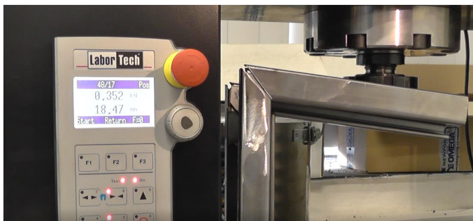
Obrázek 27. Zkouška skládaných ocelových dveřních zárubní s nezajištěným vkládaným dílem C
