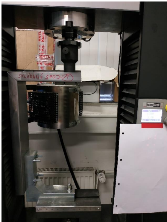
Obrázek 30 Skládaný spoj připravený pro tlakovou zkoušku
