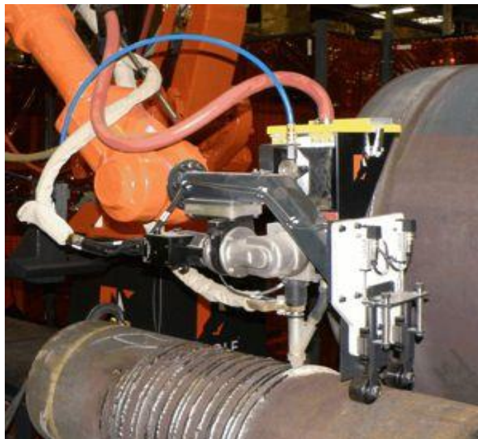
Obr. 13- Robotizované svařování pod tavidlem (SAW) [16]
