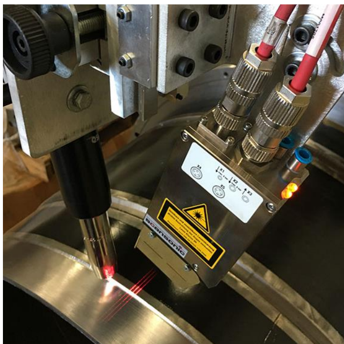
Obr. 23- Použití 3D laseru při snímání svarové mezery [27]
