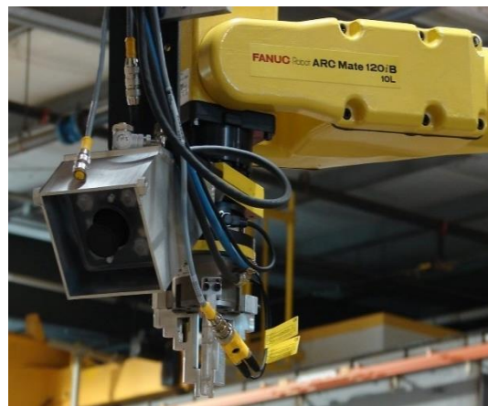
Obr. 22- 2D kamerový systém umístěný na robotu firmy FANUC [26]
