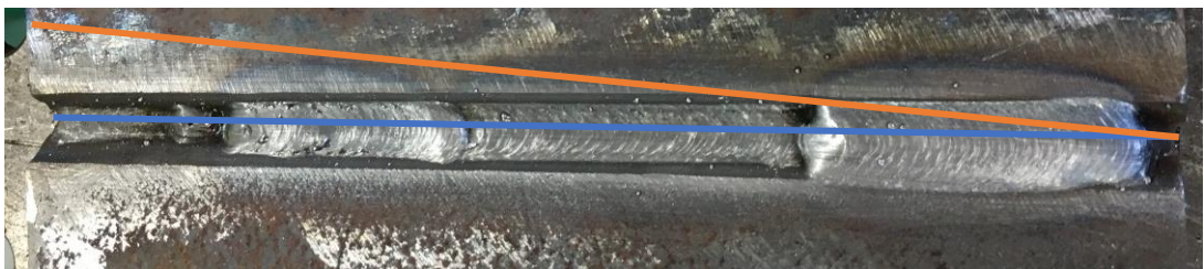
Obr. 36 – Experiment 4 (oranžová- naprogramovaná dráha, modrá- skutečná dráha)
