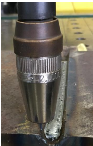
Obr. 46 - Vychýlení hořáku vlevo
