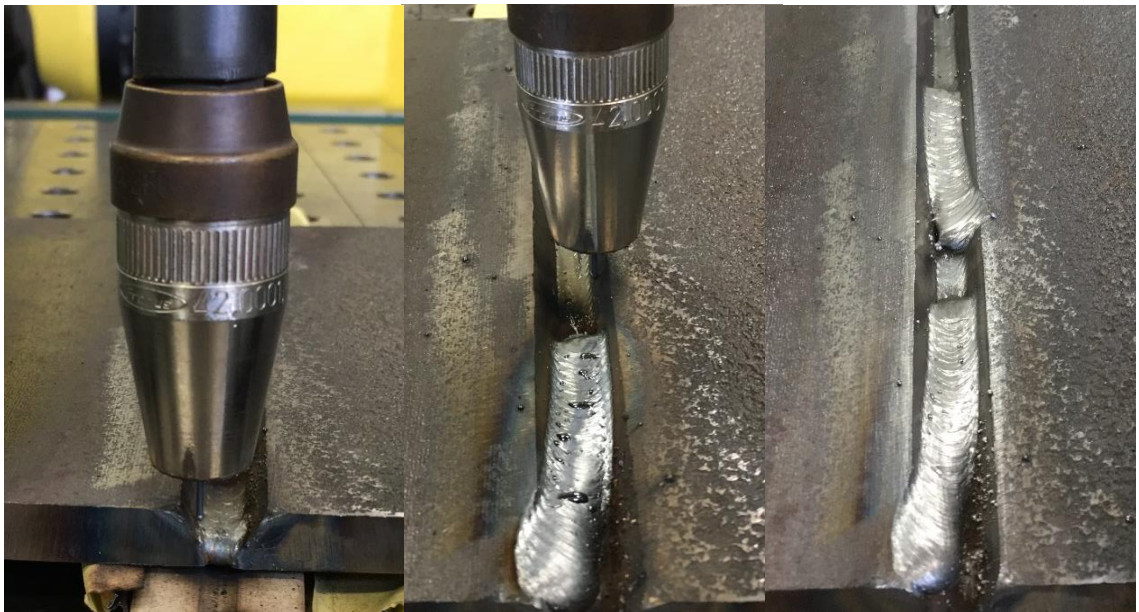
Obr. 44 - zleva: Vychýlení hořáku vlevo, vychýlení hořáku vpravo, upravení dráhy systémem TAST
