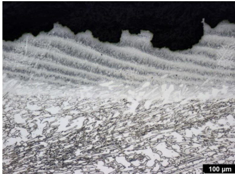
Obr. 41 Mikrostruktura povrchu materiálu EXTRA L - 1A v příčném řezu
