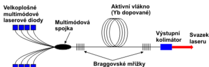
Obr. 10 Princip vláknového laseru [18]
