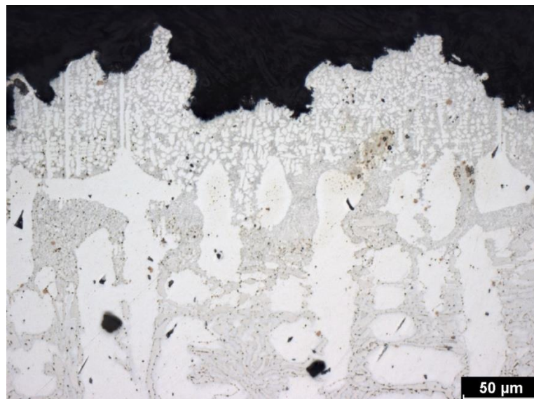
Obr. 50 Mikrostruktura povrchu materiálu EXTRA L - 5 v příčném řezu, detail
