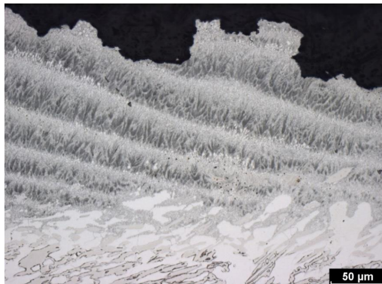
Obr. 42 Mikrostruktura povrchu materiálu EXTRA L - 1A v příčném řezu, detail
