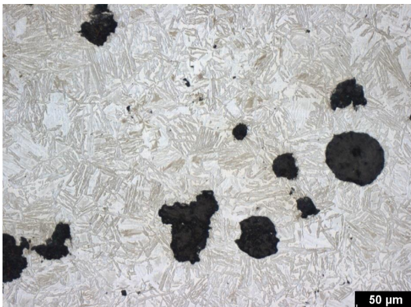
Obr. 25 Mikrostruktura LK jádra materiálu ADI 900-8, detail
