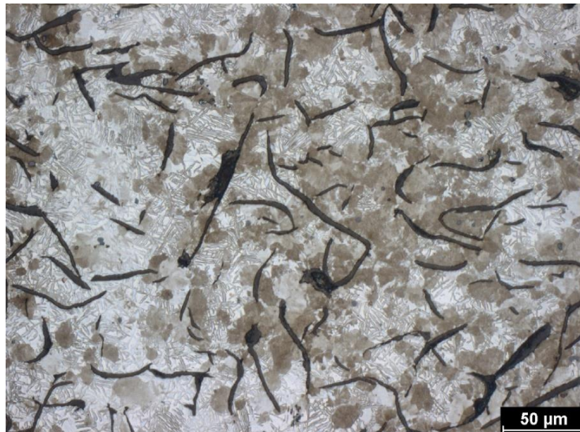
Obr. 39 Mikrostruktura IK jádra AGI GJL 250, detail
