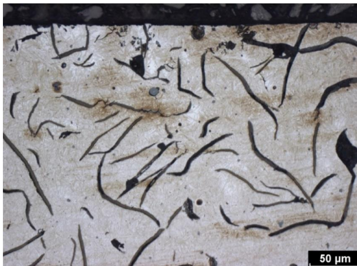
Obr. 34 Mikrostruktura LK povrchu materiálu AGI GJL 250, detail
