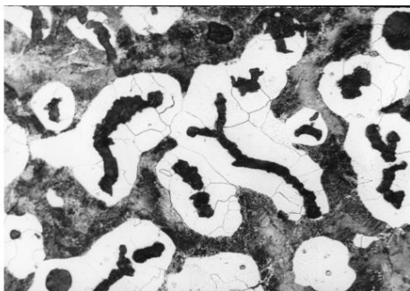
Obr. 5 Červíkovitý grafit ve feriticko-perlitické matrici [3]
