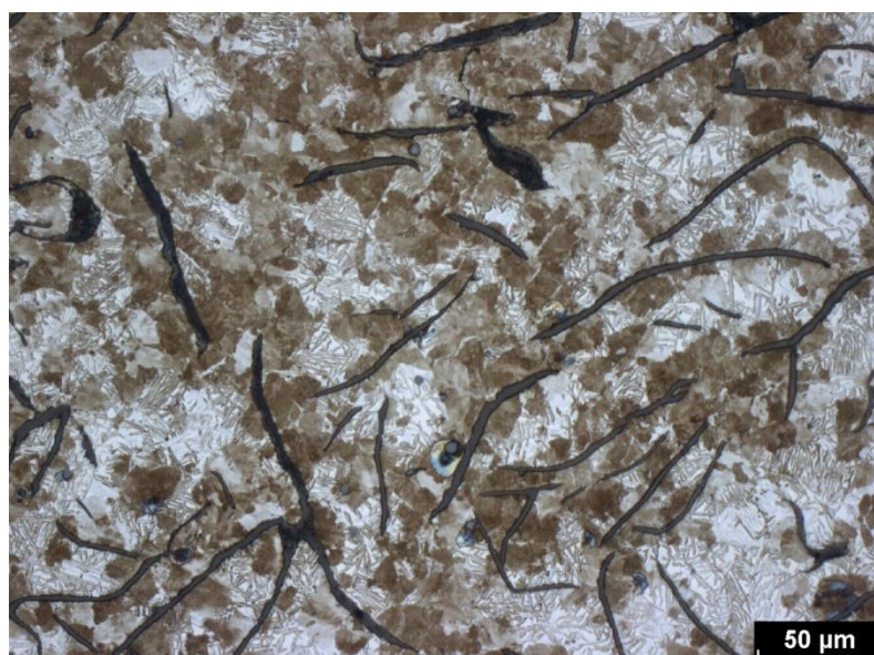
Obr. 35 Mikrostruktura LK jádra AGI GJL 250, detail
