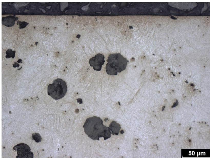
Obr. 29 Mikrostruktura IK povrchu materiálu ADI 900-8, detail
