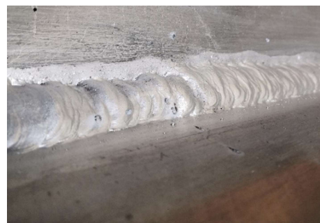
Obrázek 39 - Nadměrně převýšený svar
