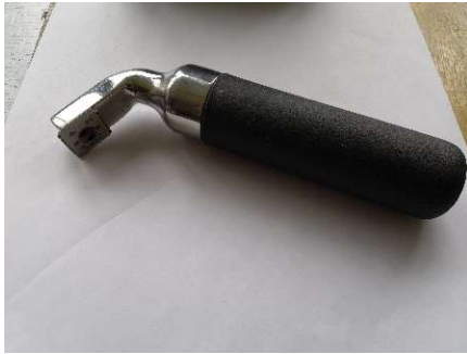
Obrázek 22 - Nástroj s břity pro mřížkovou zkoušku
