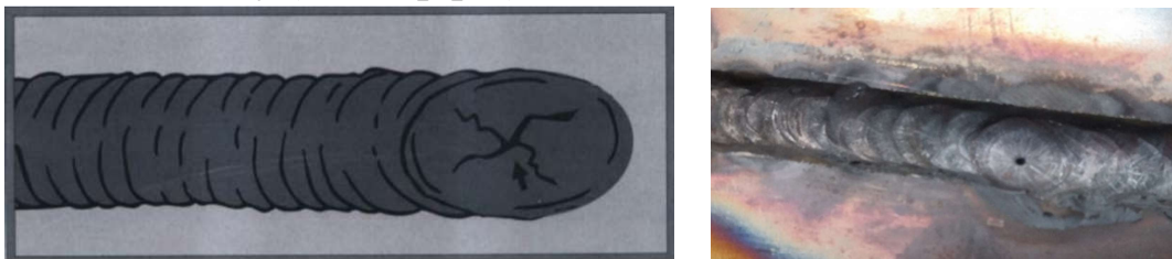
Obrázek 34 - Kráterové trhliny ve svaru [34]
