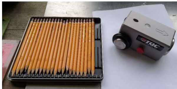
Obrázek 17 - Zkouška tvrdosti tužkovou metodou
