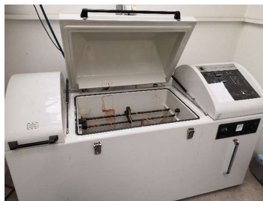
Obrázek 15 - Komora pro zkoušku v solné mlze
