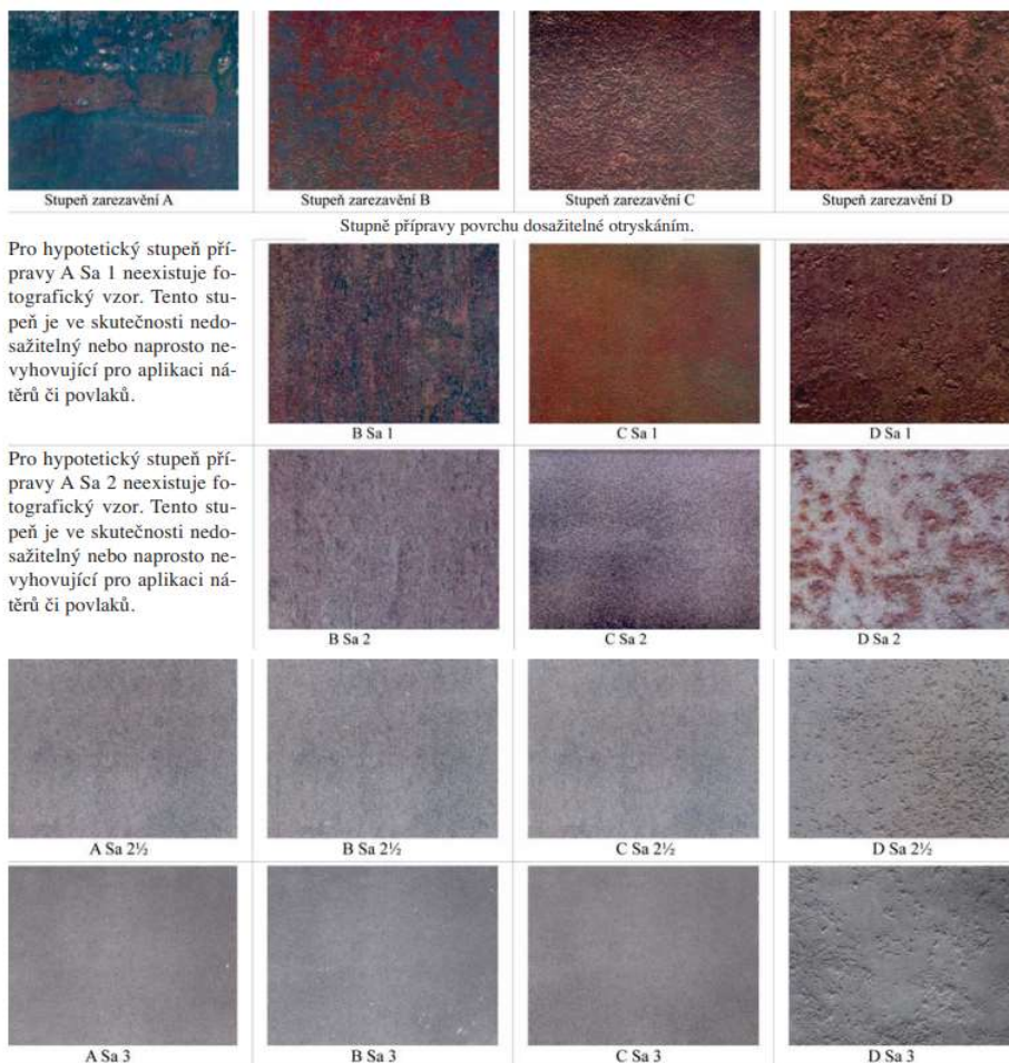
Obrázek 11 - Vzory stupňů zarezavění [12]
