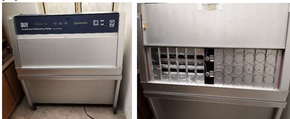
Obrázek 16 - Uzavřená a otevřená komora pro zkoušku umělým stárnutím expozicí UV zářením
