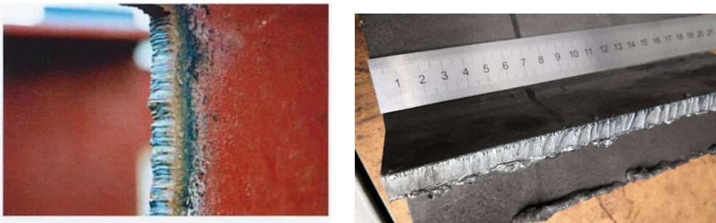
Obrázek 28 - Hrany řezané plamenem [24]
