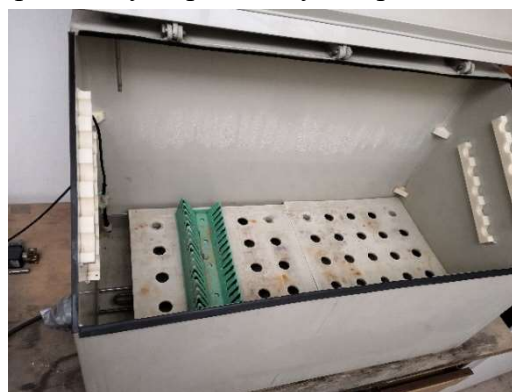
Obrázek 26 - Komoře pro zkoušku trvalou kondenzací vody
