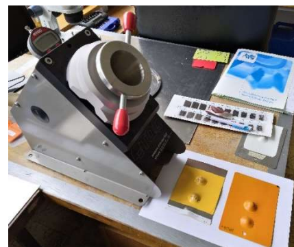
Obrázek 19 - Zkouška odolnosti při hloubení
