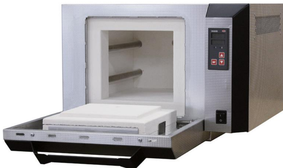
Obr. 10 Laboratorní komorová pec LE 15/11
