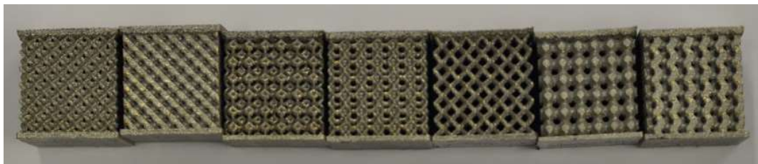
Obr. 43 Vytištěné vzorky pro zkoušku tlakem
