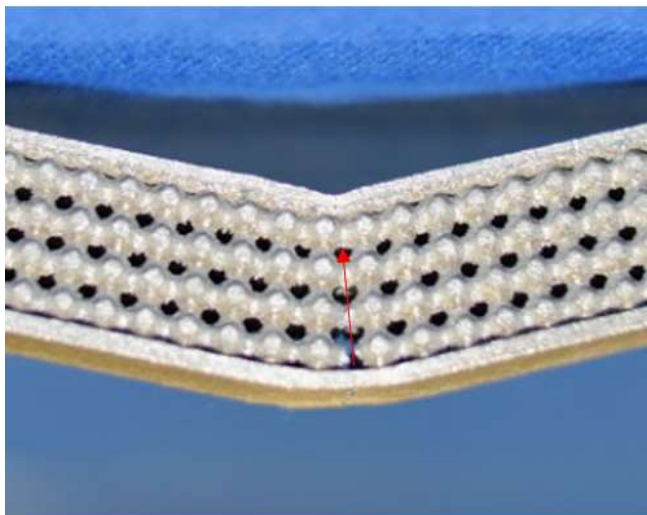
Obr. 63 Poloha a směr šíření trhliny ve vzorku A1
