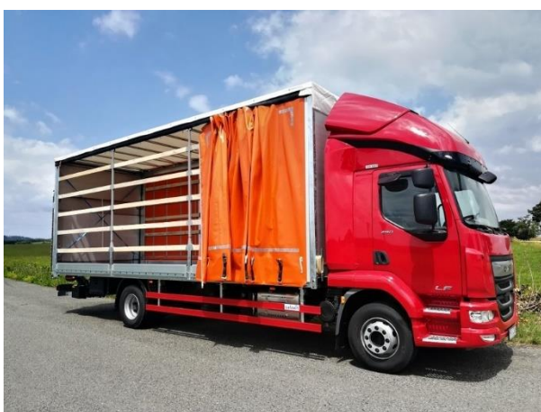
Obr. 16: Třístranná shrnovací konstrukce [14]
