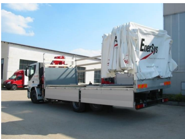
Obr. 15: Shrnovací celoplachtová konstrukce [12]
