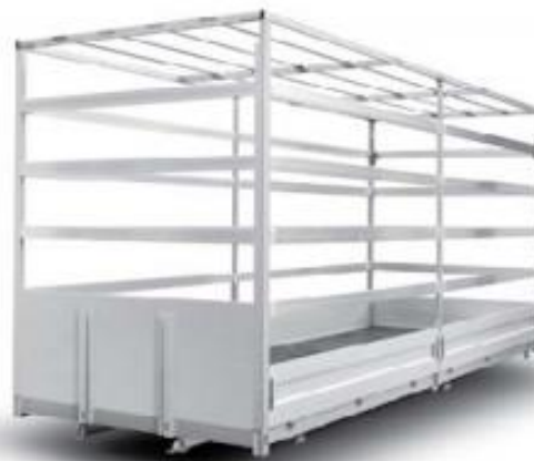
Obr. 13: Pevná plachtová konstrukce [10]
