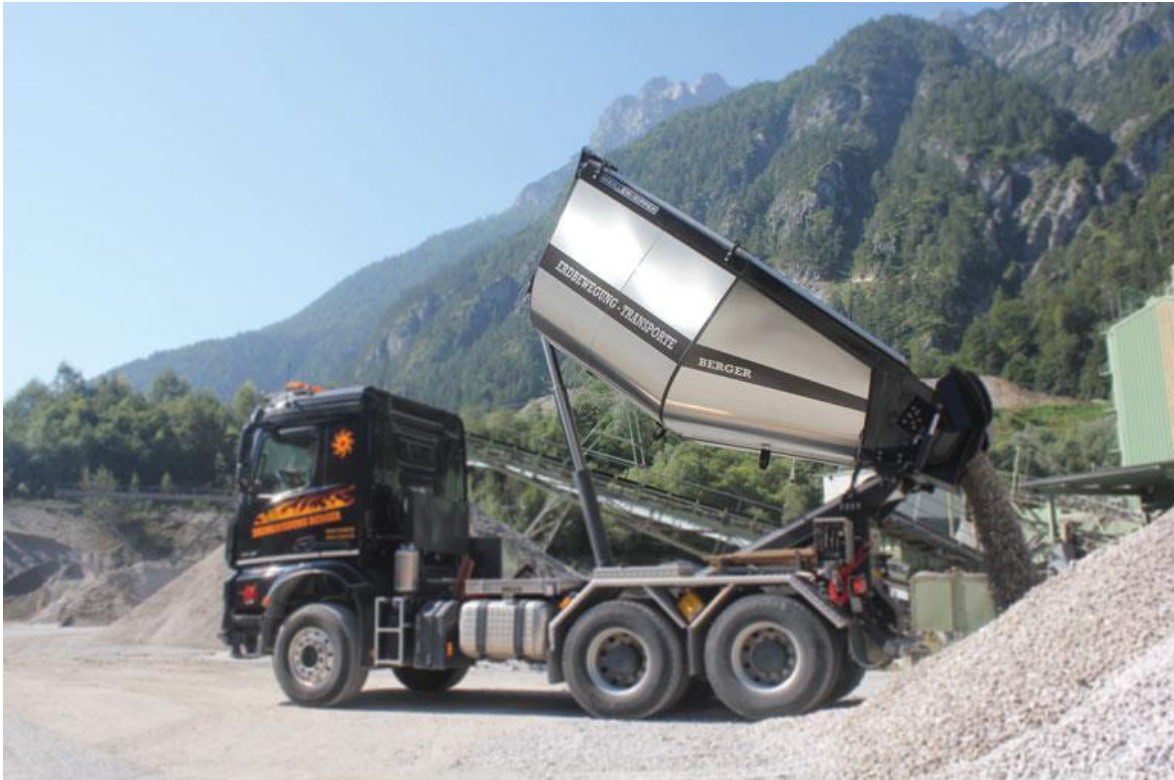
Obr. 7: Speciál od výrobce Meiller pro převoz asphaltových směsí [14]
