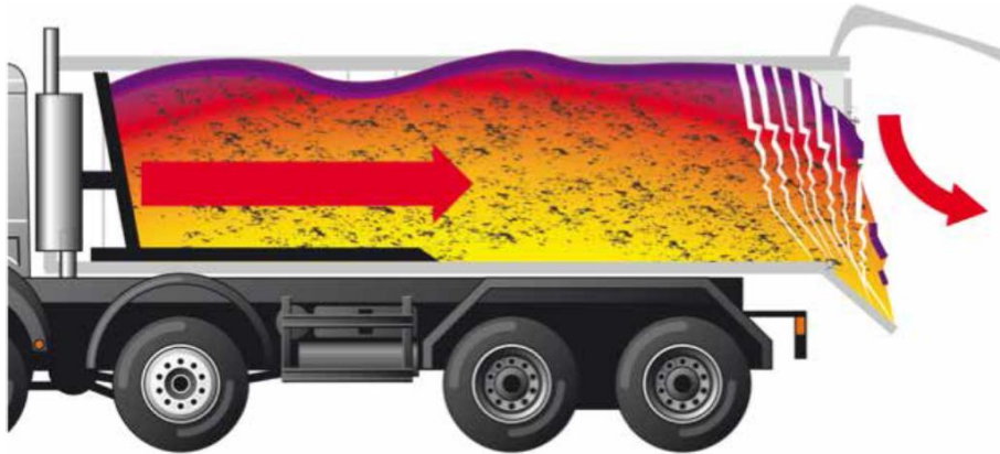
Obr. 8: Korba s vytlačovacím mechanismem [15]
