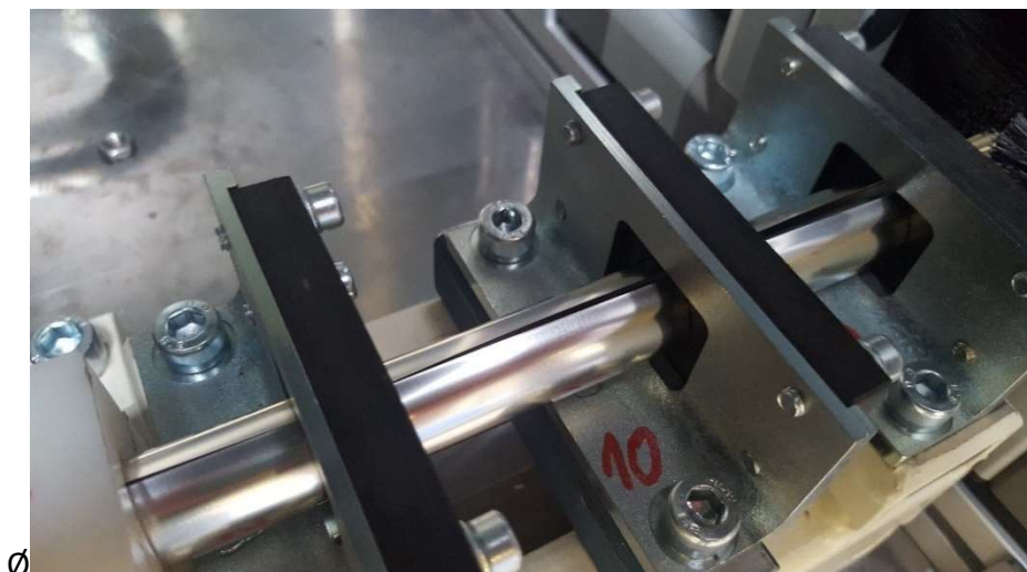
Obrázek 54 Trubka o průměru 14,6 mm před svařovacím průvlakem bez defektů na hranách pásky
