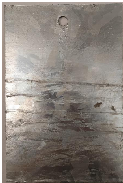
Obrázek 21: Zkušební vzorek s žárovým zinkem
