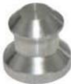
Obrázek 32: Zkušební tělísko (panenka) pro odtrhovou zkoušku [71]
