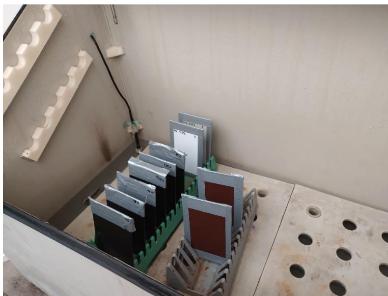
Obrázek 28: Zkušební vzorky v kondenzační komoře
