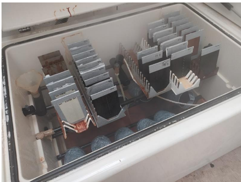
Obrázek 27: Zkušební vzorky v korozní komoře
