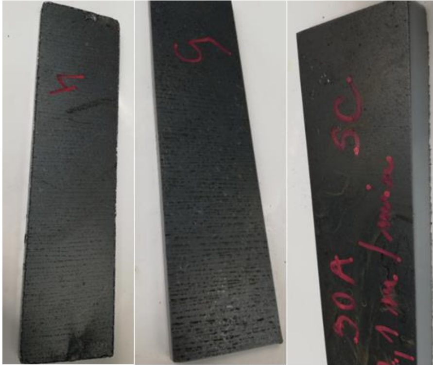
Obrázek 22 - Okuje na vzorcích 4, 5, 6
