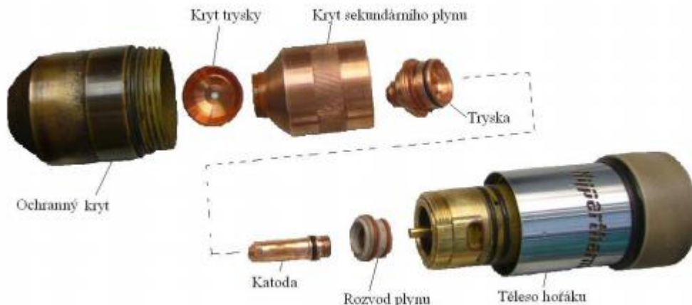
Obrázek 6 - Rozbor plazmového hořáku
