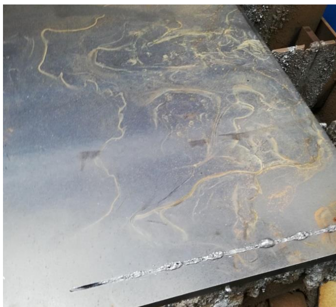
Obrázek 20 - Pokus o výpalek příliš vysokou rychlostí (pohled na horní hranu plechu)
