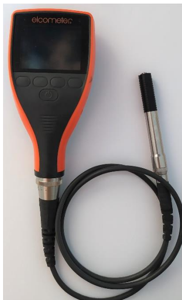
Obr 48 – Tloušťkoměr Elcometer 456T s mikrosondou na feromagnetické materiály
