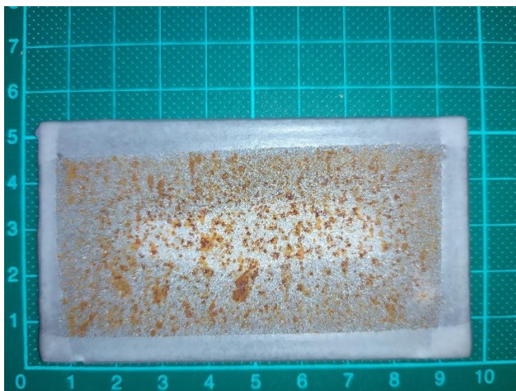
Obr 42 - 1. sada vzorek materiálu Atmofix A po 30 dnech expozice
