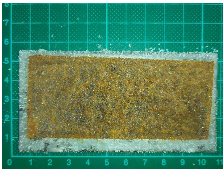
Obr 45 - 2. sada vzorek materiálu S235JR po 30 dnech expozice
