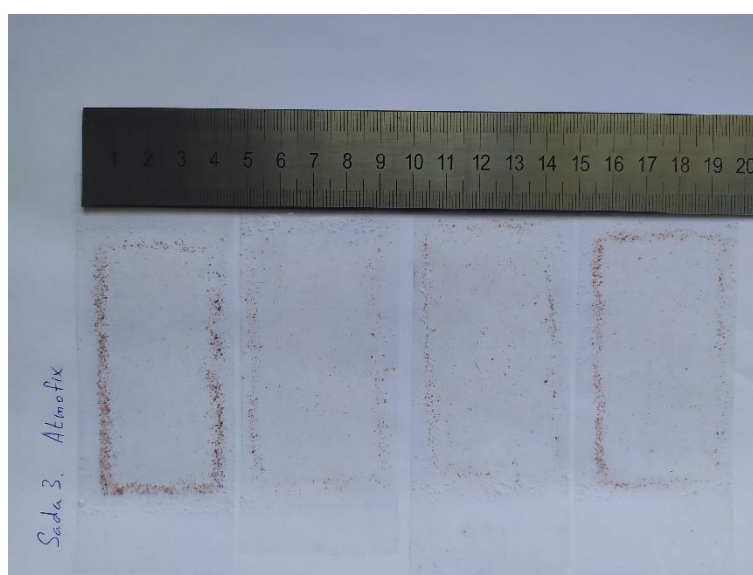
Obr 53 – Odtržené korozní produkty sada 3, materiál Atmofix A
