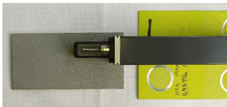
Obr 21 – Měření drsnosti vzorků směr 0°
