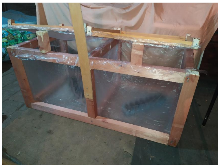
Obr 36 – Dvoukomorové zkušební zařízení v průběhu experimentu
