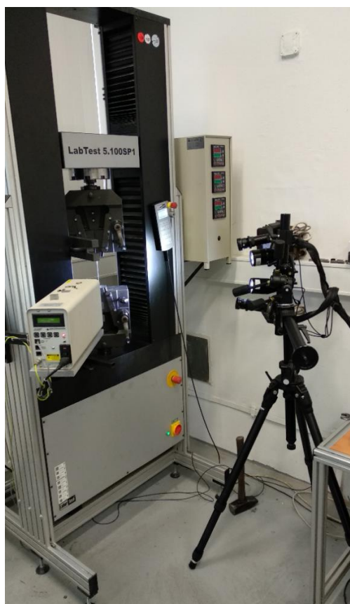
Obrázek 48: Uspořádání systému ARAMIS a stroje pro tahovou zkoušku
