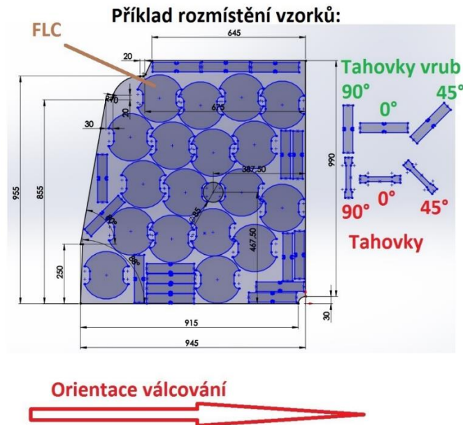
Obrázek 37: Rozměry plechu a rozmístění vzorků
