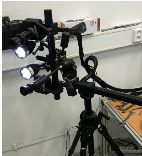
Obrázek 49: Vertikální uspořádání snímacího systému ARAMIS
