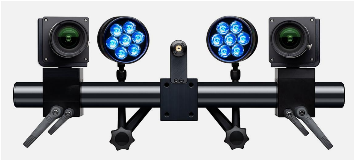
Obrázek 31: Uspořádání systému ARAMIS [35]
