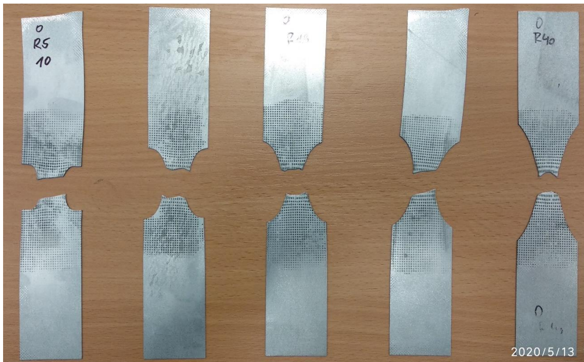
Obrázek 45: Vzorky s měrnou sítí po zatěžování
