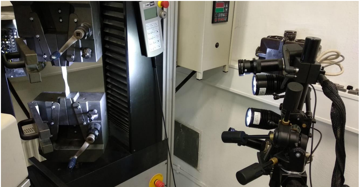
Obrázek 53: Uspořádání měřícího systému ARAMIS a zařízení pro tahovou zkoušku
