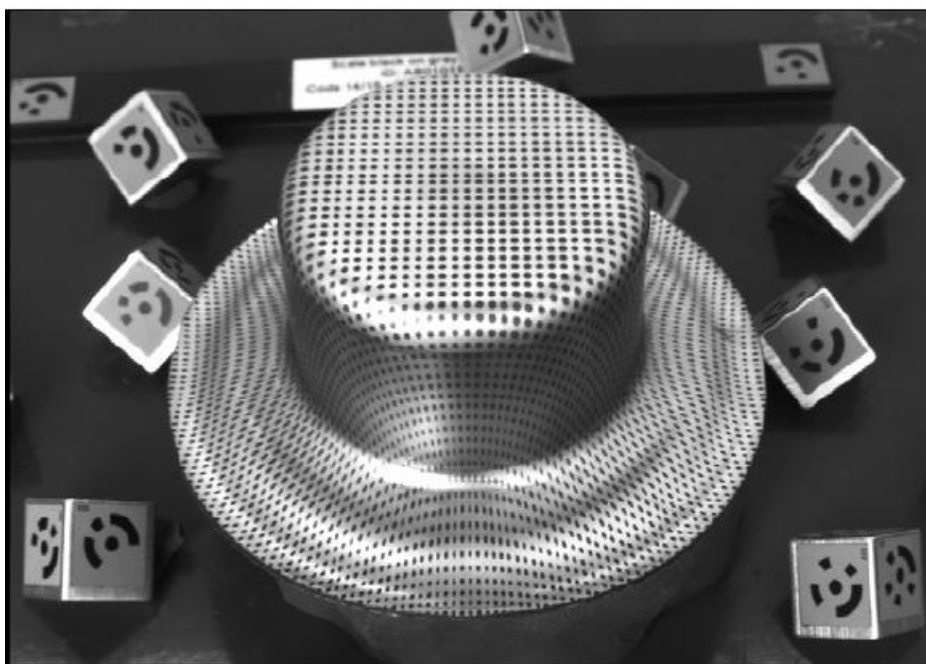
Obrázek 35: Příklad deformovaného vzorku připraveného pro snímání [2]
