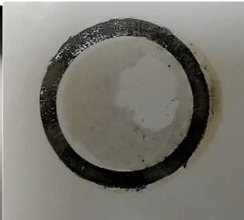
Příloha 3 Odtrh - SM130 vzorek 5 (vlevo), S280 vzorek 6 (vpravo).
