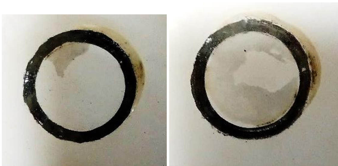
Příloha 4 Odtrh - S230/MG40 vzorek 7 (vlevo), MG40 vzorek 8 (vpravo).
