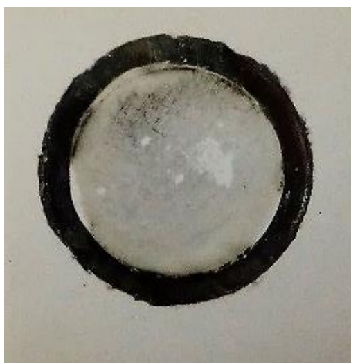
Příloha 5 Odtrh - MG40 vzorek 9 (vlevo), S170/MG40 vzorek 10 (vpravo).
