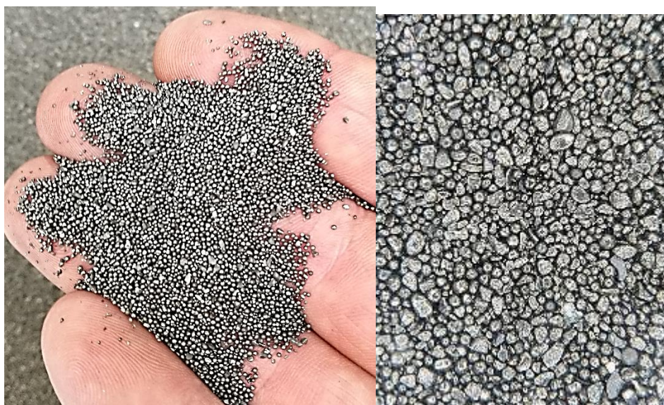
Obrázek 34 abrazivo (vlevo) směs 50 % S230 + 50 % MG40 (vpravo) směs 34 % S170 + 66 % MG40
