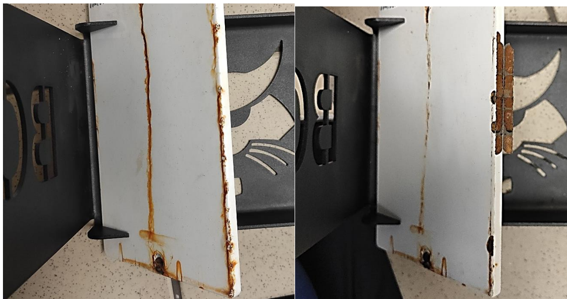
Obrázek 53 Příklad vzorku vytaženého ze solné komory (vlevo) a vyhodnocení hrany (vpravo).
