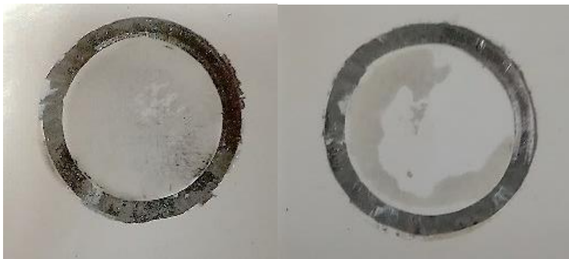
Příloha 4 Odtrh - S230/MG40 vzorek 7 (vlevo), MG40 vzorek 8 (vpravo).
