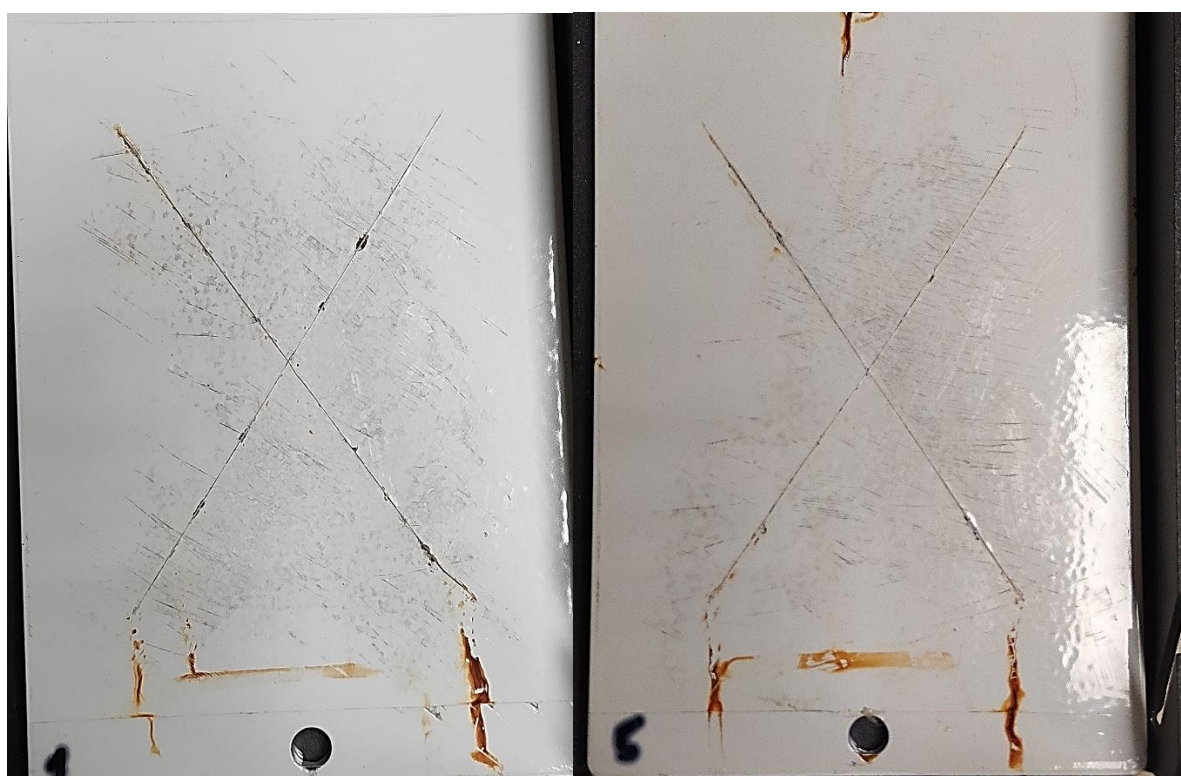
Příloha 8 Korozní zkouška 500h - SM130 vzorek 3 (vlevo), SM 130 vzorek 4 (vpravo).
