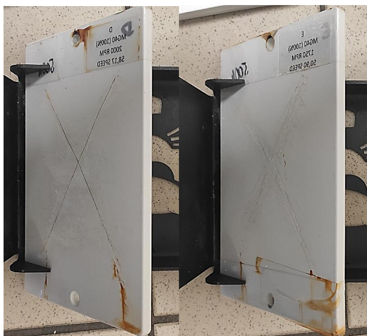
Příloha 16 Koroze na hranách – MG40 vzorek 8 (vlevo), MG40 vzorek 9 (vpravo).
