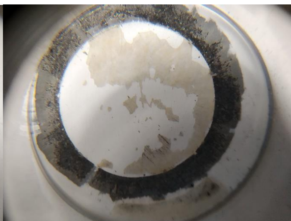
Příloha 2 Odtrh - SM130 vzorek 3 (vlevo), SM130 vzorek 4 (vpravo).
