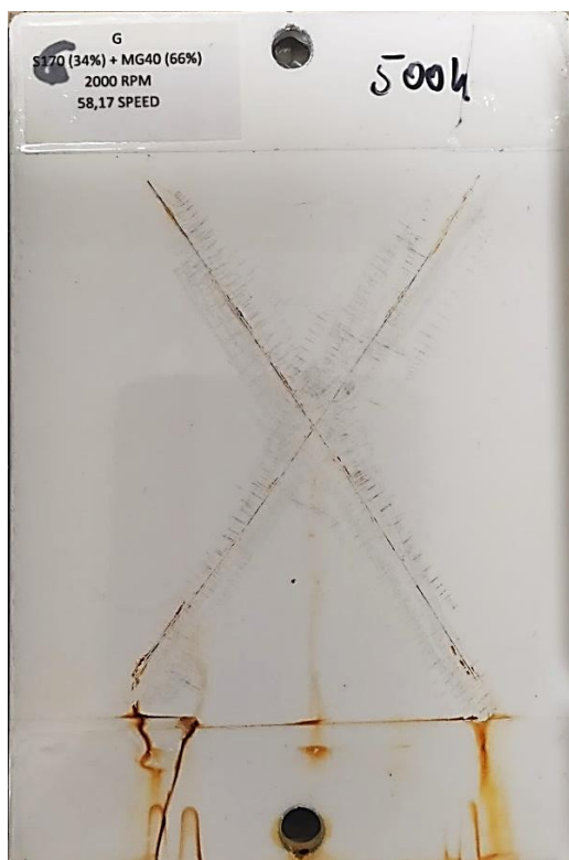
Příloha 12 Korozní zkouška 500h - S170/MG40 vzorek 11
