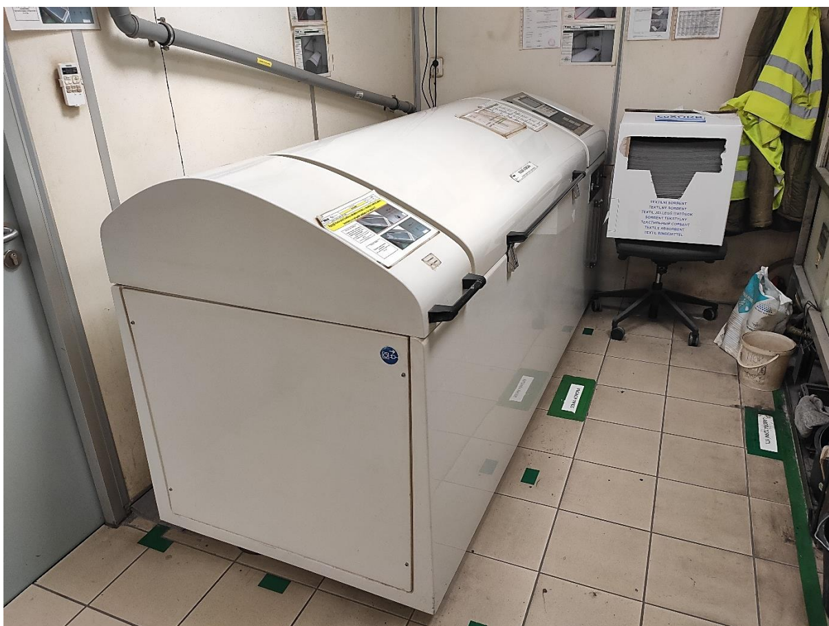
Obrázek 47 Zařízení (solná komora) značky Liebisht CONSTAMATIC
