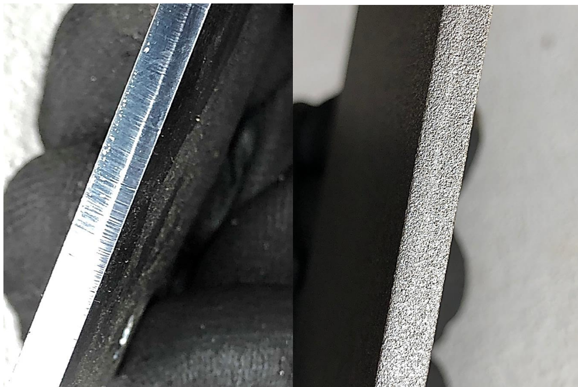
Obrázek 52 Příklad hrany s okujemi před (vlevo) a po otryskání bez okují (vpravo).
