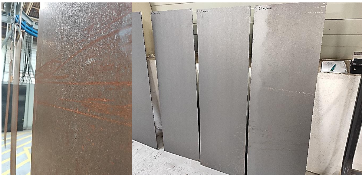
Obrázek 39 Testované vzorky plechů před vjezdem do tryskací jednotky (vlevo) a po otryskání (vpravo).
