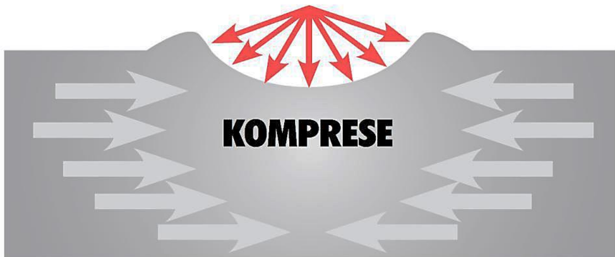
Obrázek 8 Schéma principu kuličkování [13]
