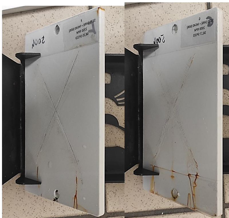
Příloha 17 Koroze na hranách – S170/MG40 vzorek 10 (vlevo), S170/MG40 vzorek 11 (vpravo).
