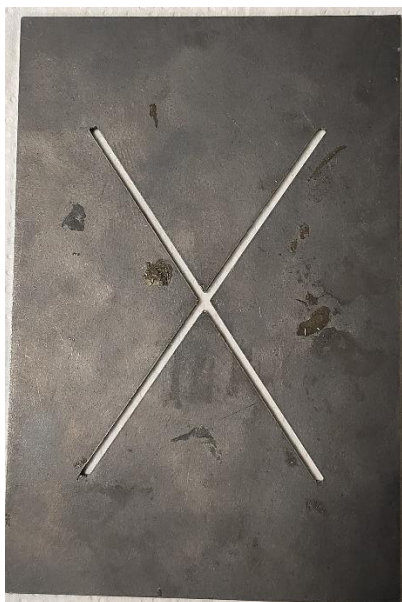
Obrázek 45 Šablona k provedení křížového řezu před vkládáním do solné komory.
