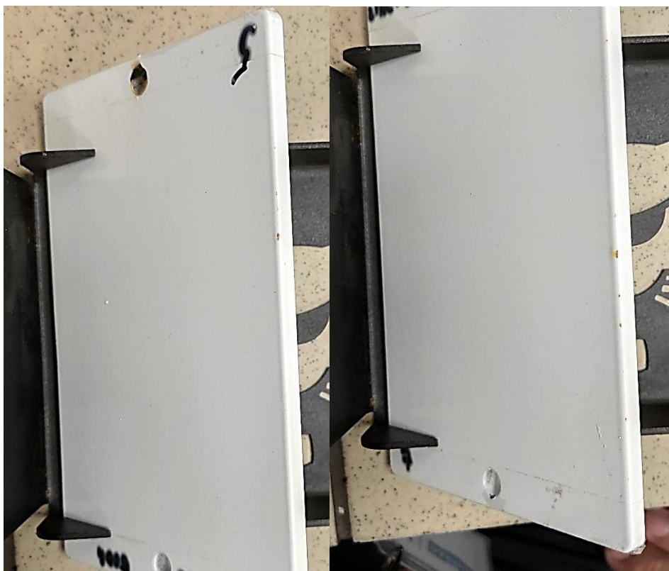
Příloha 14 Koroze na hranách – SM130 vzorek 4 (vlevo), SM130 vzorek 5 (vpravo).
