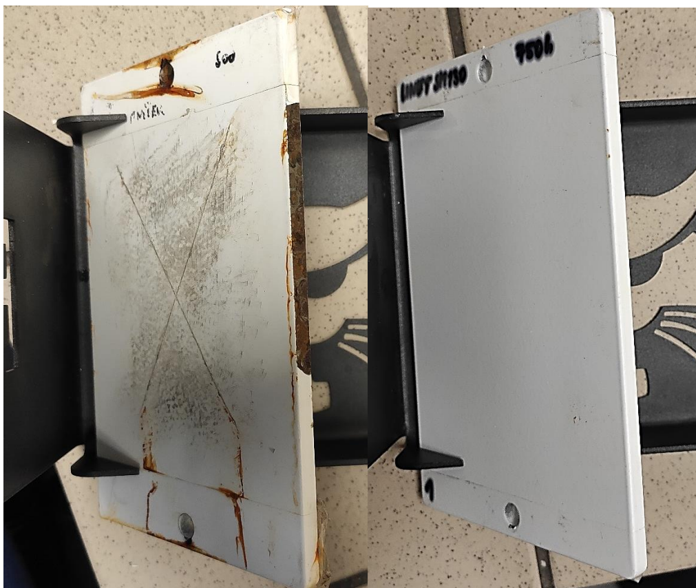
Příloha 13 Koroze na hranách – SM130 vzorek 2 (vlevo), SM 130 vzorek 3 (vpravo)
