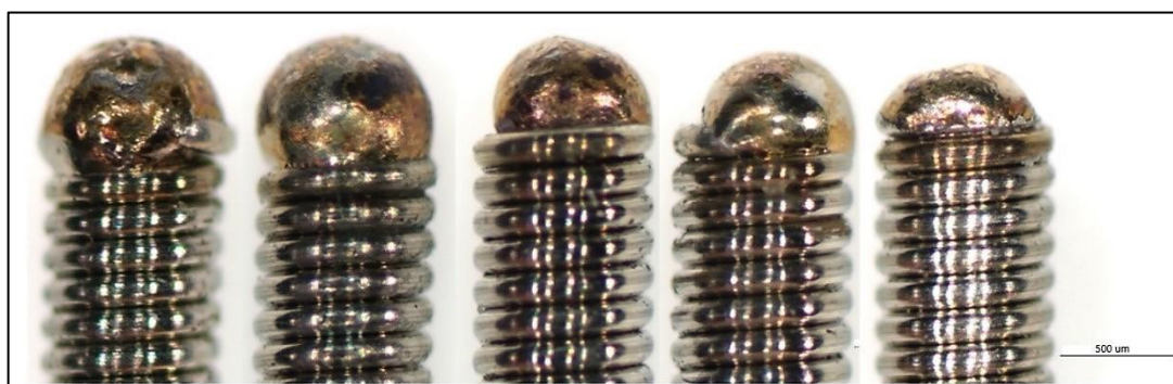
Obrázek 40: Vliv postupně zvyšované fokusační vzdálenosti na geometrii svaru, zleva: fokus (0, +2, +4, +6, +8) mm
