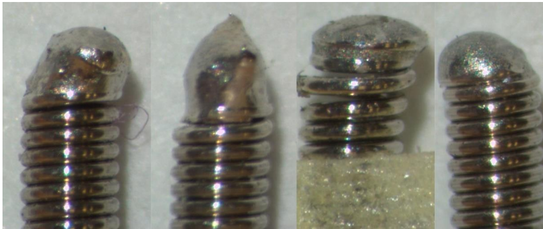
Obrázek 23: Nevyhovující spoje s nedostatečným natavením materiálu ( 200 \mu\text{A} ) [1]
