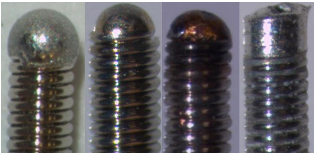
Obrázek 34: Srovnání spojů NiTi+SS zhotovených různými technologiemi (zleva: EBW, LBW, mikrotig, pájení)
