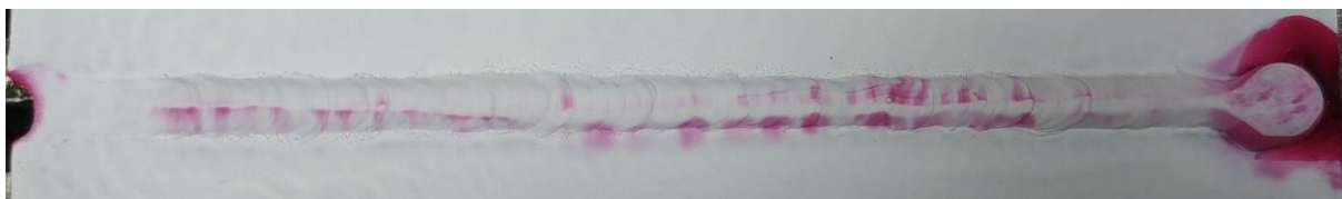
Obrázek 30: kapilární zkouška vzorku MIG_3
