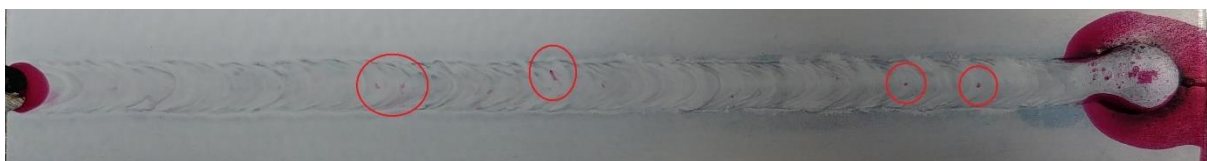
Obrázek 31: kapilární zkouška vzorku MIG_4
