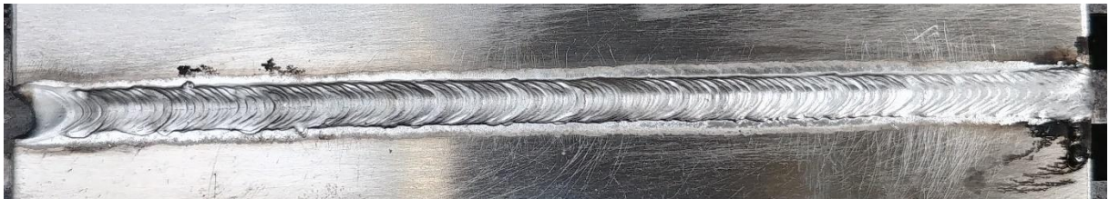
Obrázek 21: Krycí vrstva vzorku MIG_2
