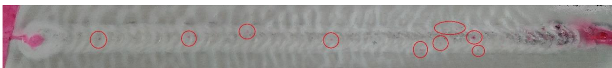
Obrázek 54: Kapilární zkouška TIG_2
