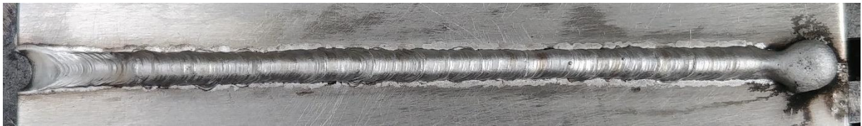
Obrázek 22: Krycí vrstva vzorku MIG_3
