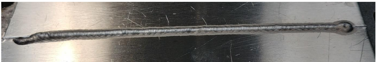
Obrázek 52: Kořen svaru vzorku TIG_3
