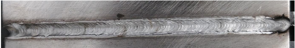
Obrázek 20: Krycí vrstva svaru MIG_1
