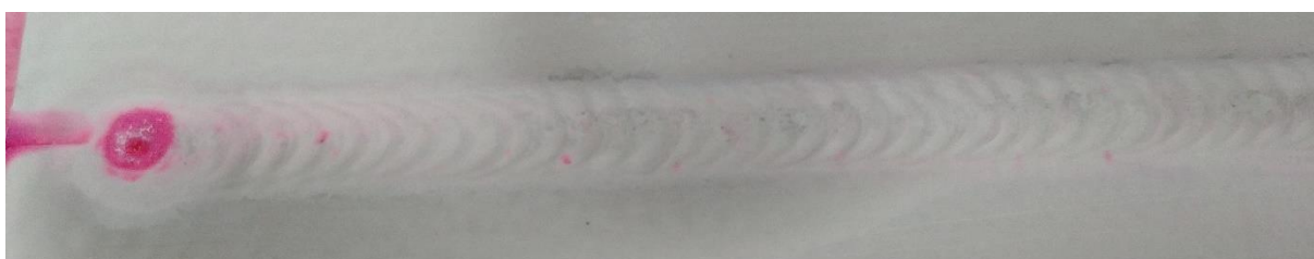
Obrázek 56: Kapilární zkouška TIG_3 detail
