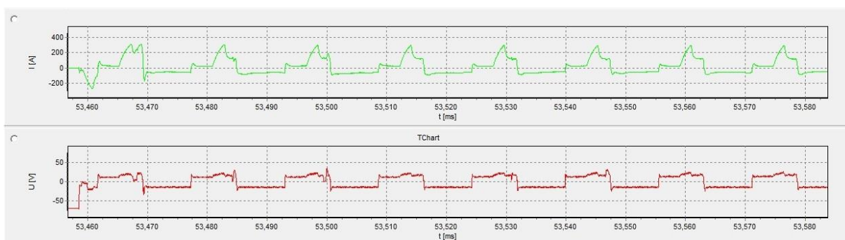
Obrázek 19: Průběh proudu a napětí MIG_4
