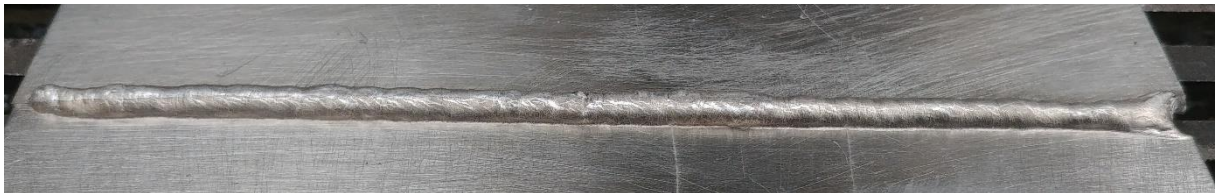
Obrázek 24: kořen svaru MIG_1
