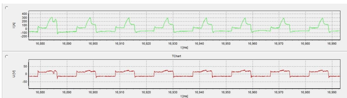
Obrázek 16: Průběh proudu a napětí MIG_1
