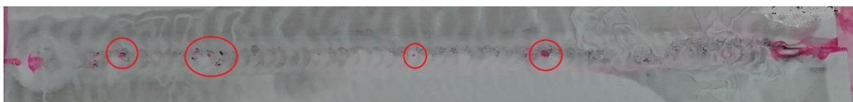
Obrázek 53: Kapilární zkouška TIG_1
