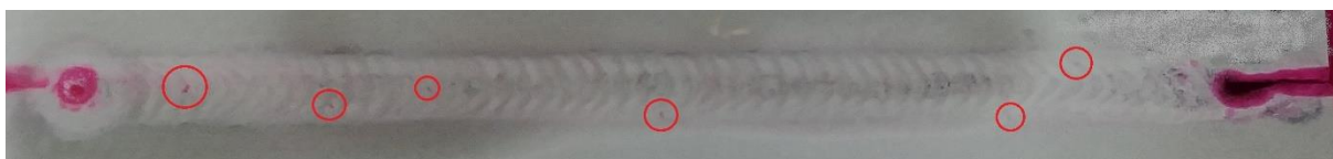
Obrázek 55: Kapilární zkouška TIG_3
