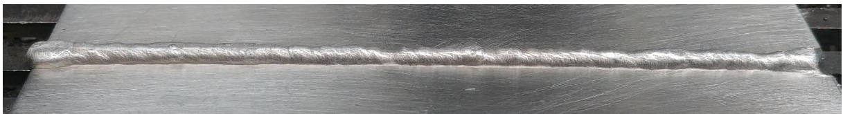
Obrázek 25: kořen svaru MIG_2
