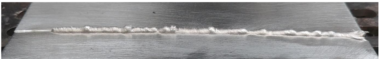
Obrázek 27: kořen svaru MIG_4
