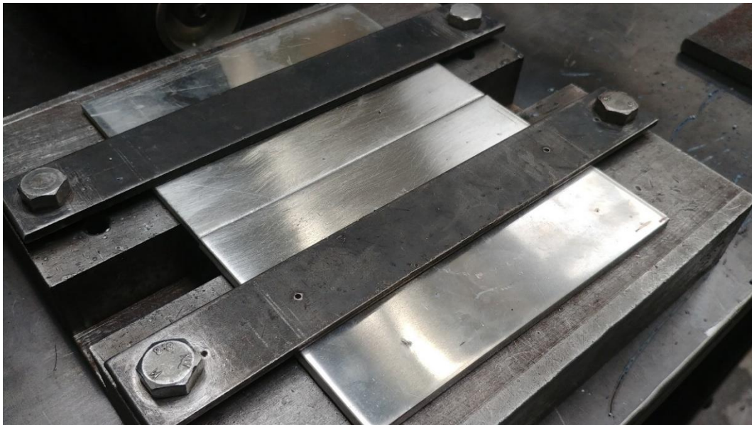
Obrázek 13: Upnutí plechů v přípravku
