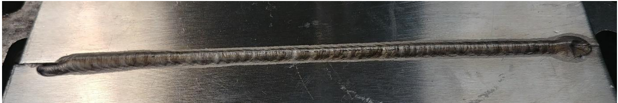
Obrázek 50: Kořen svaru vzorku TIG_1
