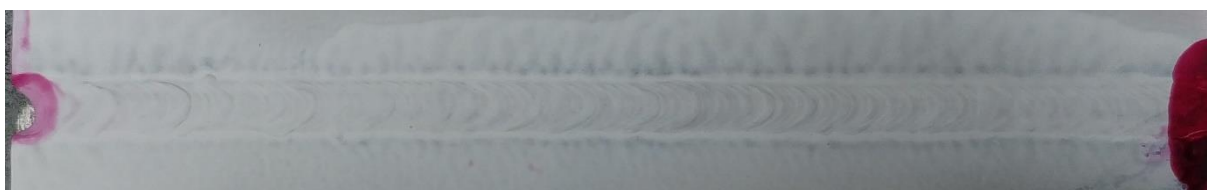
Obrázek 29: kapilární zkouška vzorku MIG_2
