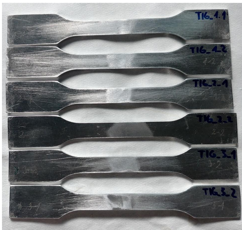
Obrázek 63: Zkušební vzorky pro tahovou zkoušku TIG AC
