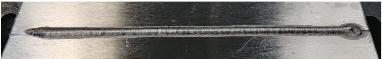
Obrázek 51: Kořen svaru vzorku TIG_2
