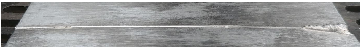
Obrázek 26: kořen svaru MIG_3
