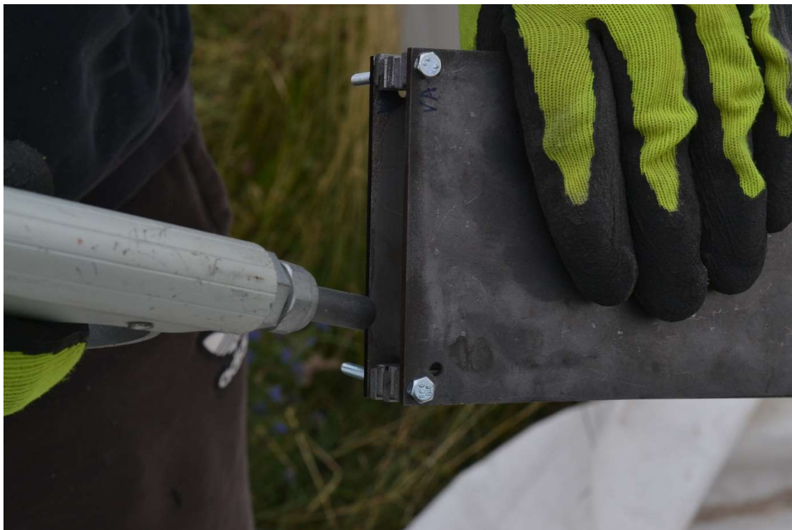
Obrázek 17 - Abrazivní tryskání pomocí křemičitého písku ST 06/12 PA50
