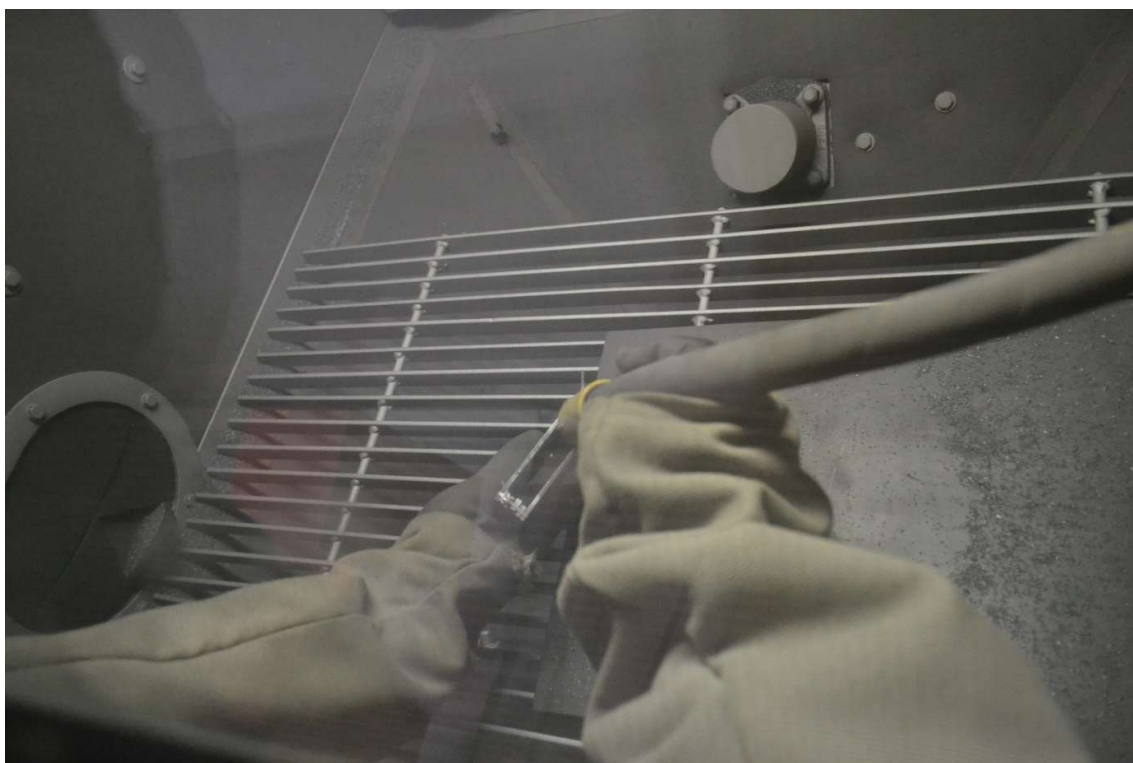
Obrázek 14 - Abrazivní tryskání pomocí ocelové drtě GL25 (štěrbina 20 mm)
