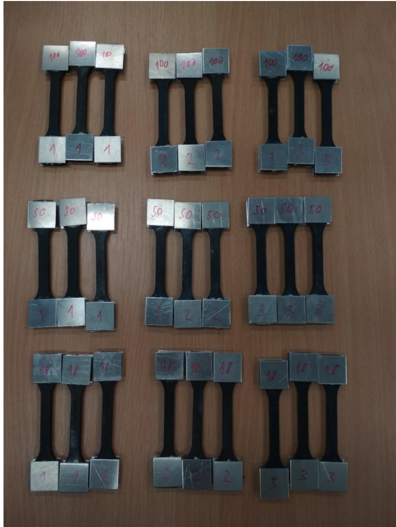
Obrázek 4.6.1 Vzorky před tahovou zkouškou
