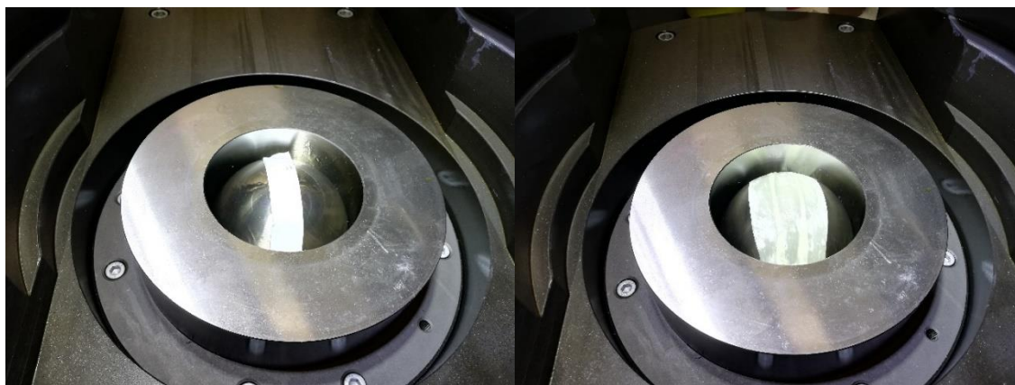
Obr. 26, Lubrikace tažníku k eliminaci tření mezi tažníkem a zkušebním vzorkem
