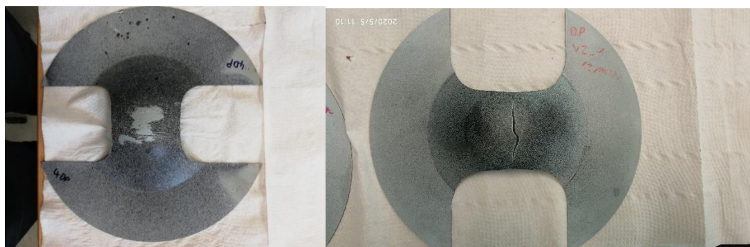
Obr. 22, Porovnání špatně a správně odmaštěného vzorku
