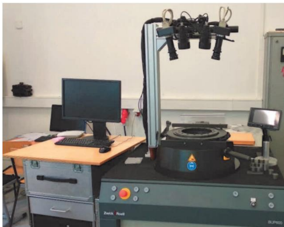
Obr. 29, Měřicí zařízení BUP 600 se systémem ARAMIS 4M Adjustable [24]
