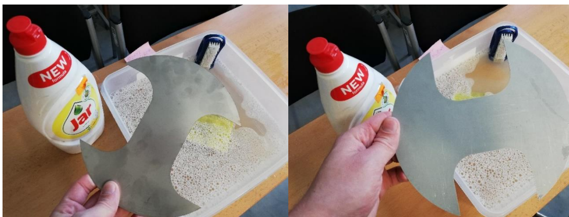
Obr. 21, Odmaštění a očištění vzorku
