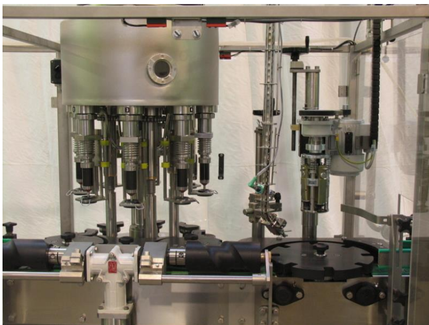
Obrázek č. 18 Linka na stáčení lihovin do lahvíček 0,05 a 0,2 l pro Rudolf Jelínek – Vizovice, výrobce Altec Chotěboř [17]
