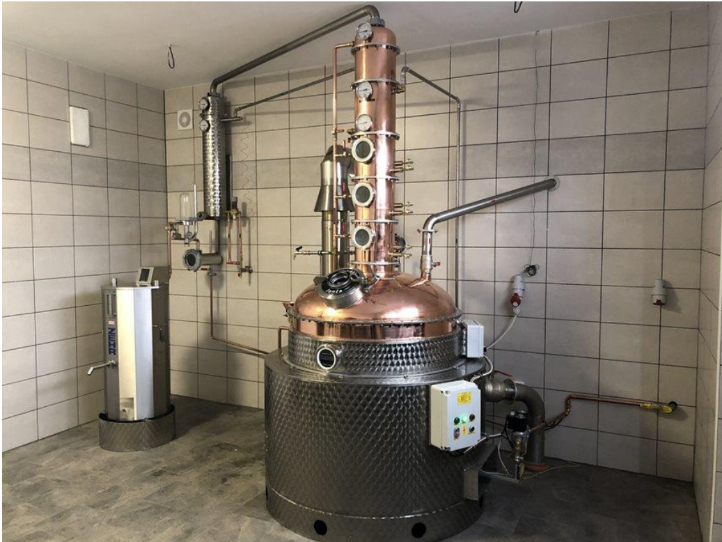
Obrázek č. 13 Jednotková kolona vytápěná plynem s deflegmátorem a katalyzátorem 300 l, Jastrabie nad Toplou (SK), výrobce Kovoděl Janča, s. r. o. [34]
