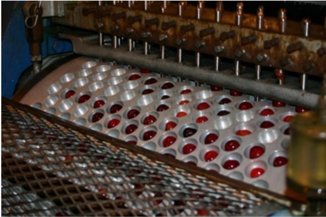
Obrázek č. 11 Pohled do vnitřku odpeckovacího stroje [30]
