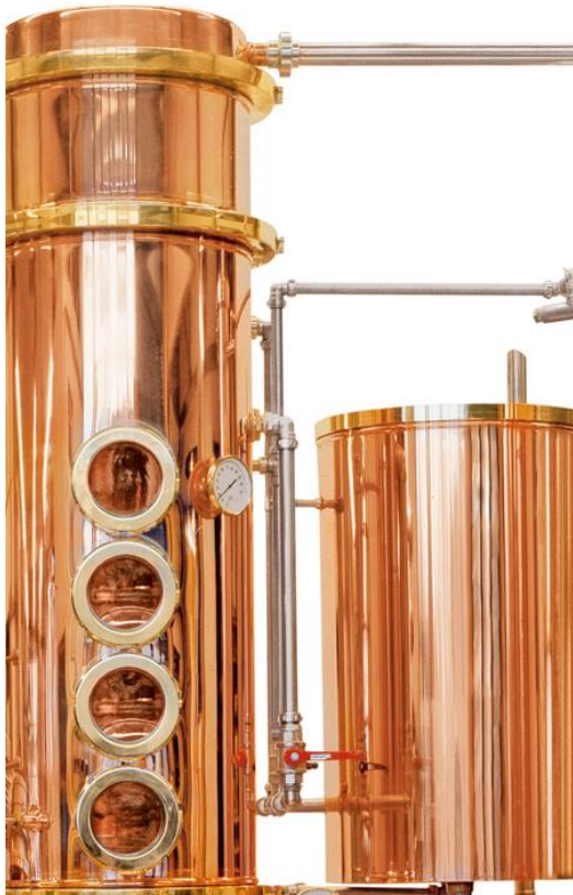
Obrázek č. 15 Měděný katalyzátor pro odstraňování kyanovodíku, lamelová konstrukce, pro vertikální instalaci nad deflegmátor, výrobce Arnold Holstein [18]
