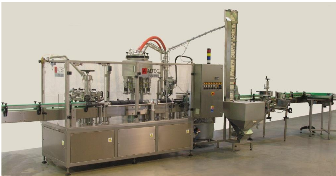
Obrázek č. 17 Linka na stáčení lihovin do lahvíček 0,05 a 0,2 l pro Rudolf Jelínek – Vizovice, výrobce Altec Chotěboř [17]
