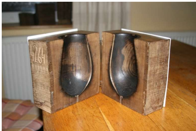
Obr. 7 Dřevěná sklářská forma po několikátém použití [13]
