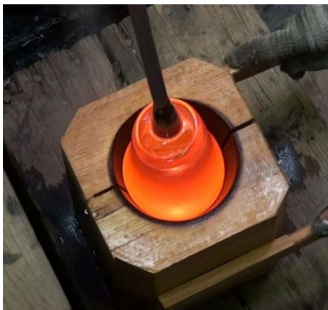
Obr. 5 Dřevěná forma na zpracování skla [12]
