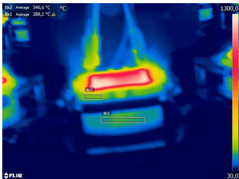
Obr. 25 Infračervený snímek zapalování hran čtyřmi plynovými hořáky, pozice 4
