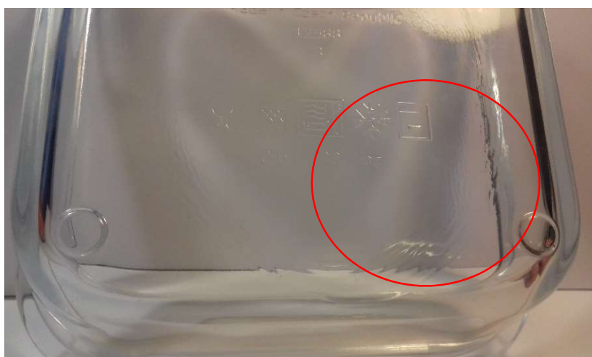
Obr. 36 Viditelné vrásnění - gramofon na dně nádobky
