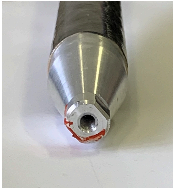
Obr. 3.3: Detail vlepované koncovky
