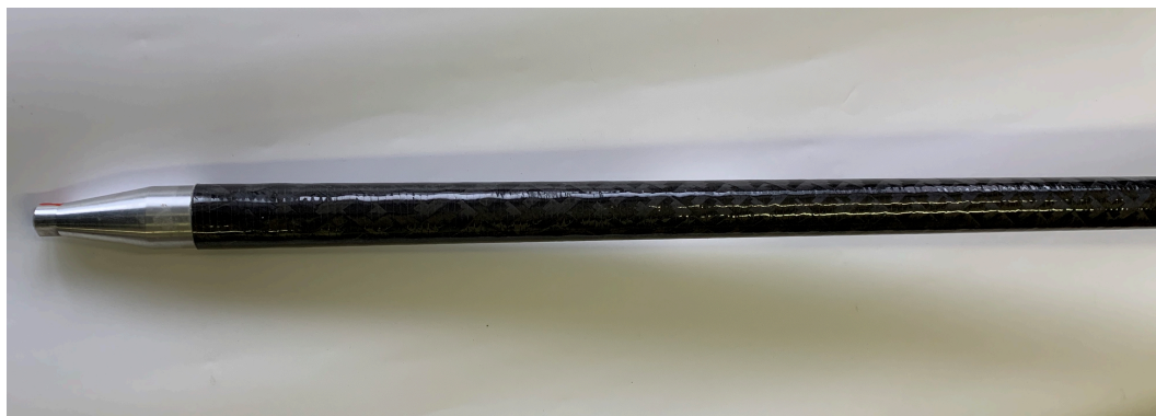
Obr. 3.2: Táhlo z kompozitního materiálu
