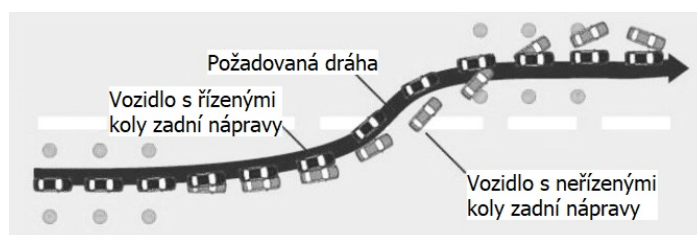
Obrázek 5.5: Porovnání vozidla s řízenými a neřízenými koly zadní nápravy při úhybném manévru ve vysoké rychlosti [28].
