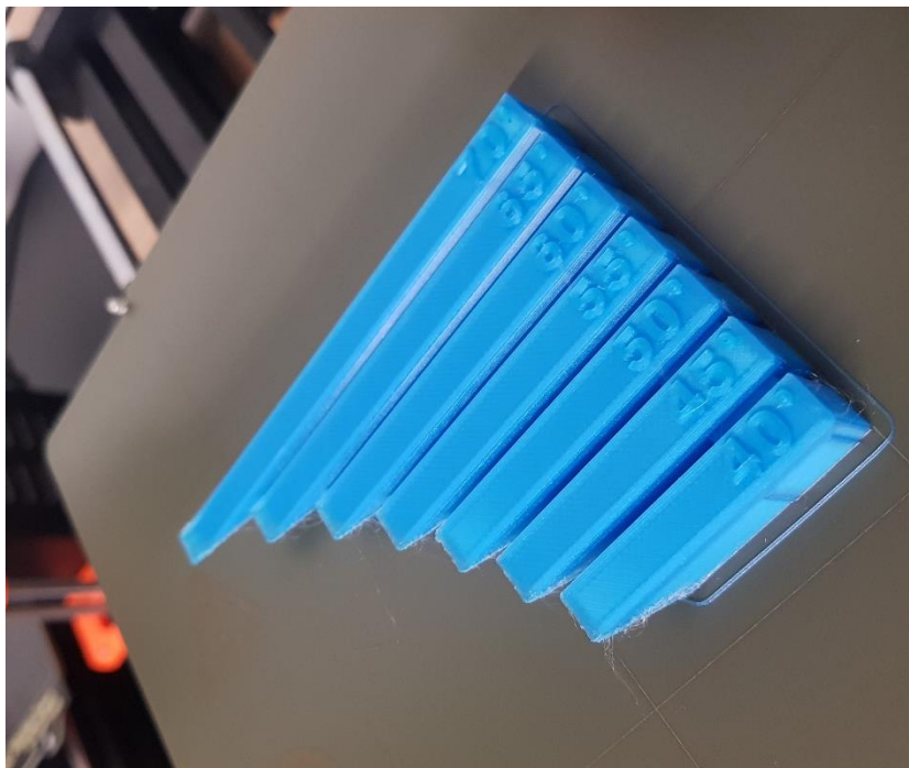
Obrázek 25: Tištěné těleso pro zkoušku sklonu
