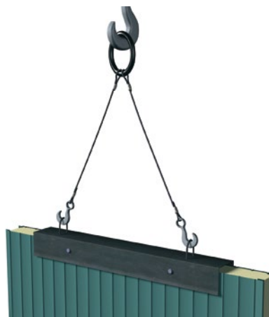
obr. 4.12.6: manipulace s panelem AWP při svislém kladení panelů („U-nosič“)
