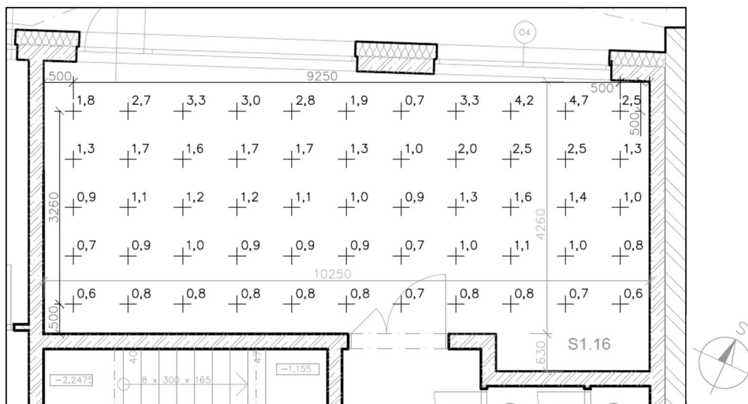
Obr. 37: Půdorys místnosti S1.16 s vyznačenou polohou kontrolních bodů dle ČSN EN 17037 [8] a stanovené v nich hodnoty činitele denní osvětlenosti
