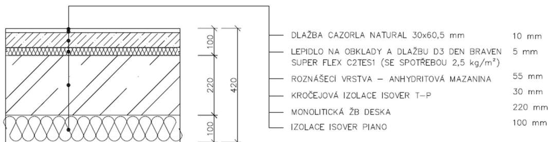
Obr. 15: Skladba podlahy mezi vytápěným a temperovaným prostorem
