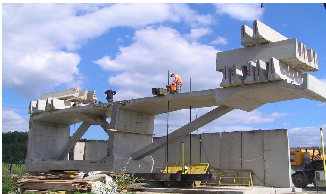
Obrázek 24 Zatěžovací zkouška příčného řezu [7]
