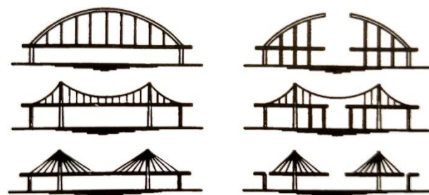
Obr. 38: Porovnání výstavby obloukových, visutých a zavěšených konstrukcí [11]
