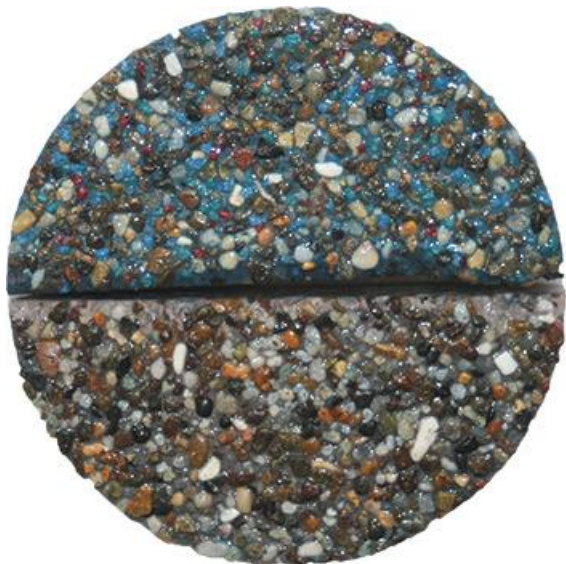
Obrázek č.35 – Příklad blednutí skleněných agregátů; foto aquamagazine.com
