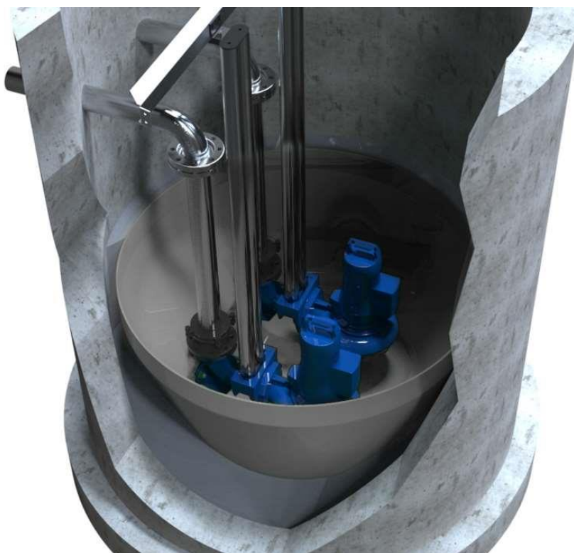
Obrázek č.30 – Příklad plastové vložky v malé betonové nádrži; Schema delta-p-online.com
