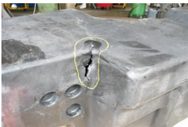
Obrázek č. 55 a 56 – Oprava praskliny v nádrži; Foto ACEmobileplastic.com.au
