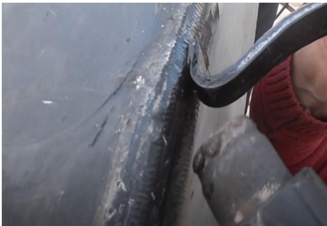
Obrázek č.17 – Sváření plastu horkovzdušnou pistolí a svařovacími proužky
