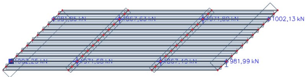
obr. 2.4 a 2.5 Reakce při zatížení vlastní tíhou na modelech se šikmostí 75° a 40°
