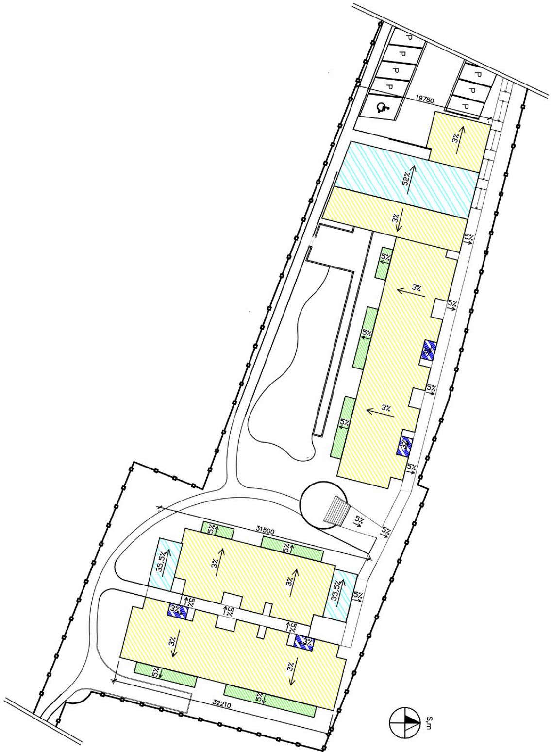
Obr. 23: Schéma střešních rovin
