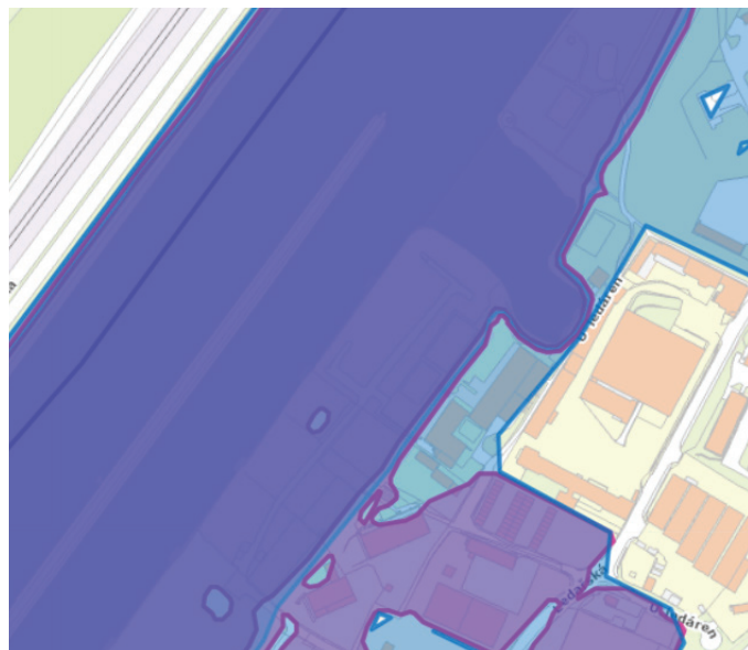
Průtok stoleté vody s PPO, 4020 m 3 /s
