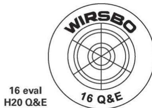
Obr. 15. Označení roztahovacích hlavíc Quick & Easy 16 Q&E – hlavice do trubek Uponor PEX-a 16 eval – hlavice do trubek Uponor evalPEX-a (Q&E) H2O Q&E – hlavice pro hydraulický nástroj do trubek Uponor PEX-a
