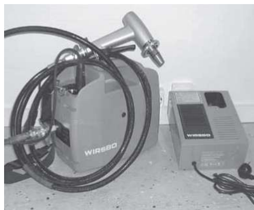
Obr. 17. Hydraulický akumulátorový nástroj GHA 550, 9,5 kg s pistolí Q&E 40-550 (1,5 kg)
