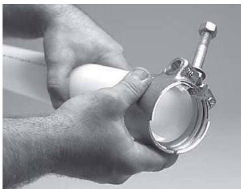
Obr. 7. Nasunout vnější objímku na trubku a pak umístí trubku na trn (čep) spojky WIPEX.
