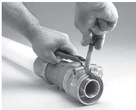
Obr. 6. Zabezpečit šroub svorkami a sejmout upínací objímku ze spojky.
