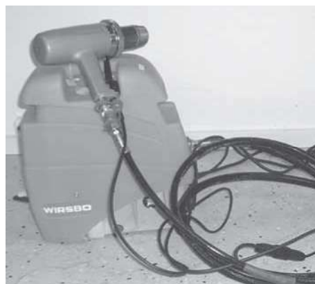
Obr. 18. Hydraulický nástroj napájený ze sítě 230 V PHE 550, 17 kg, s pistolí Q&E 68-550 (3,3 kg)
