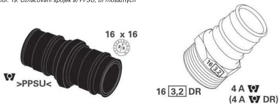
Obr. 19. Označování spojek a) PPSU, b) mosazných
