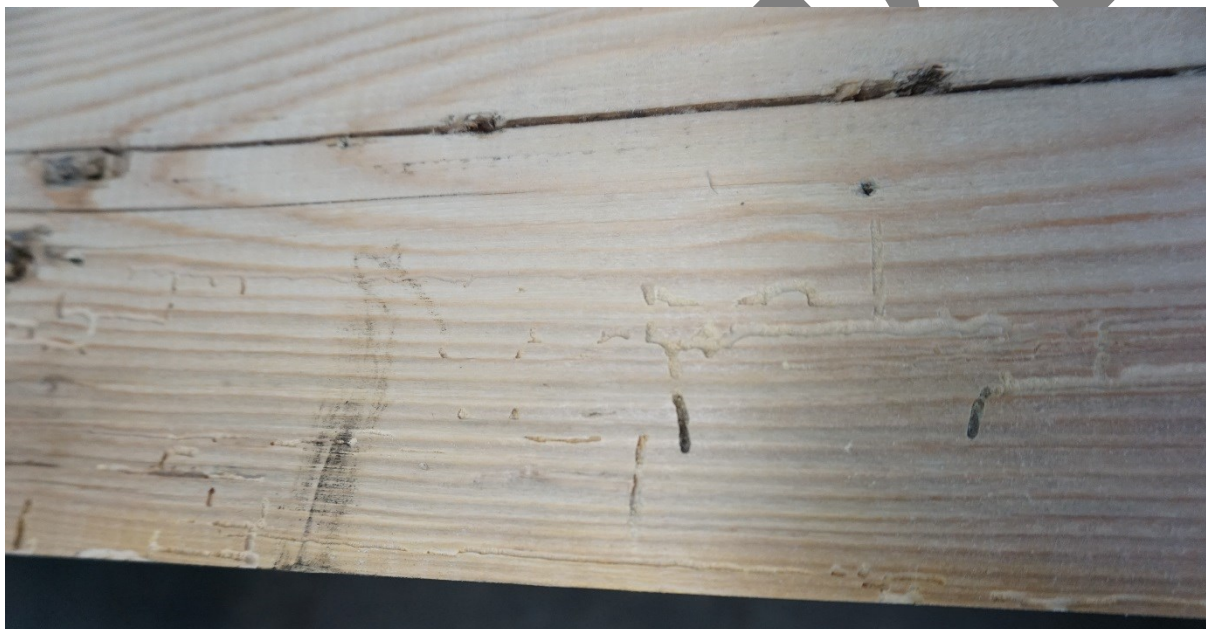
Obrázek 2: Zkušební těleso T1-2 pro 4bodový ohyb – poškození dřevokazným hmyzem zjištěné při výrobě zkušebních těles
