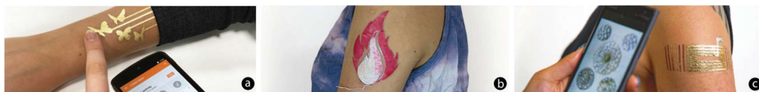
Obrázek 3 - Prototypy interaktivního tetování DuoSkin, a) První typ, b) Druhý typ, c) Třetí typ
