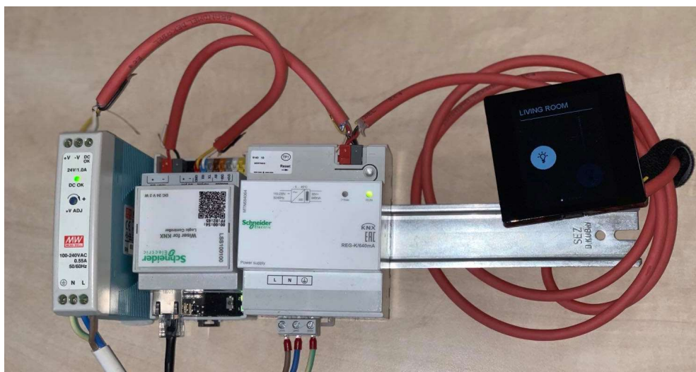
Obrázek 5 - Model inteligentního řídicího systému s využitím KNX
