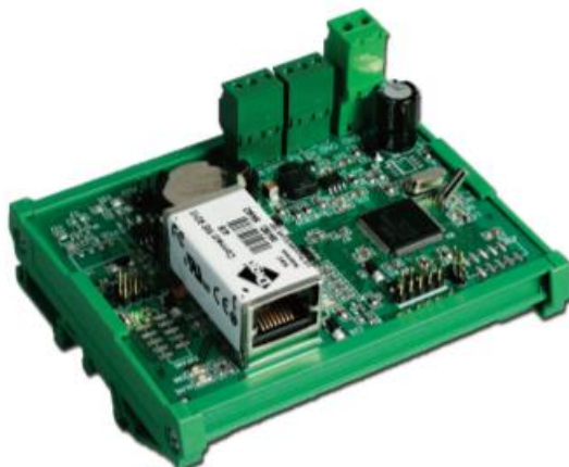
Obrázek 5 Řídicí modul DIGI CAN (zdroj: addat.cz)
