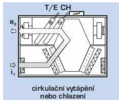
Obr. 16 Cirkulační vytápění nebo chlazení [5.3]
