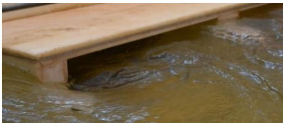
Obrázek 41 Ukázka snížení hladiny vlivem výtoku, tvorba víru
