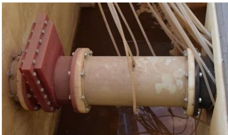
Obrázek 45 Spodní výpust část (šoupě, profil Tlak D), začátek konfuzoru
