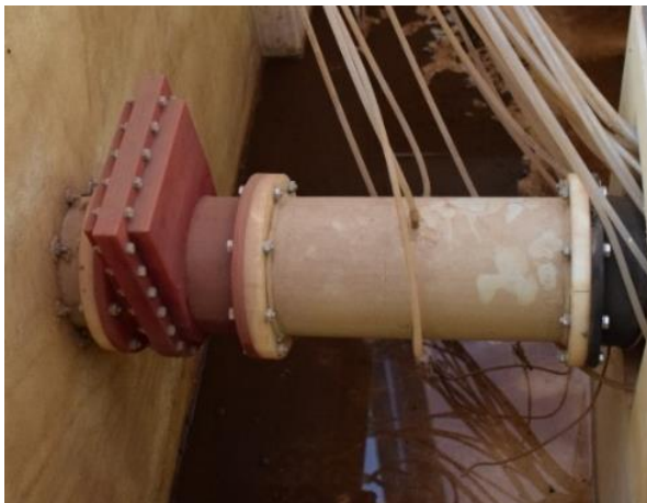
Obrázek 8 Část potrubí spodní výpusti – šoupě, profil Tlak D
