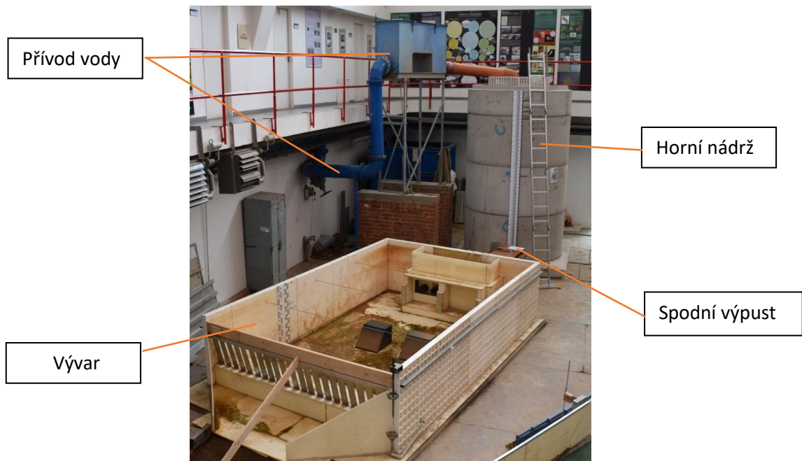
Obrázek 2 Fyzikální model Vodní dílo Vranov - Spodní výpust s koncovým regulačním segmentovým uzávěrem
