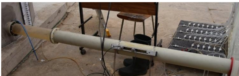
Obrázek 42 Spodní výpust - potrubí mezi Horní nádrží a vývarem
