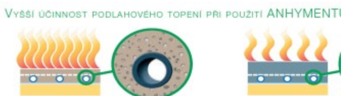
Obr. 20 - Příklad zalití potrubí - anhydrit vs. cementový potěr[6]
