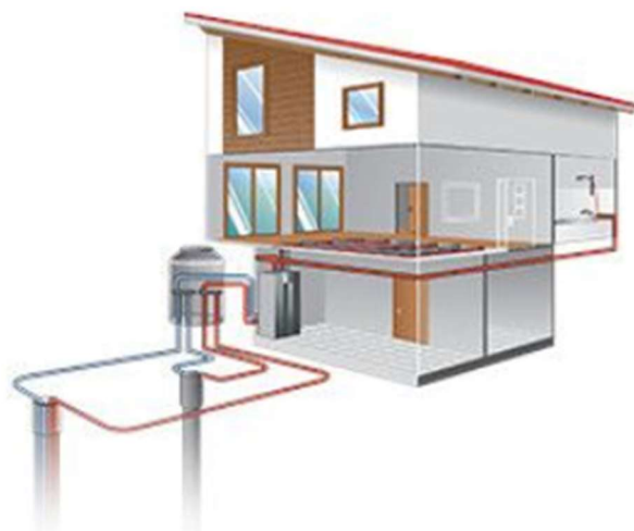
Obrázek 20: Tepelné čerpadlo země/voda s geotermálními vrty [19]
