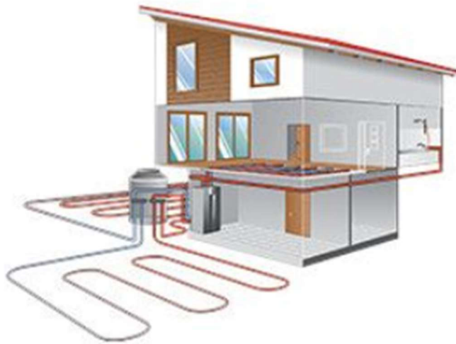
Obrázek 19: Tepelné čerpadlo země/voda se zemním kolektorem [19]
