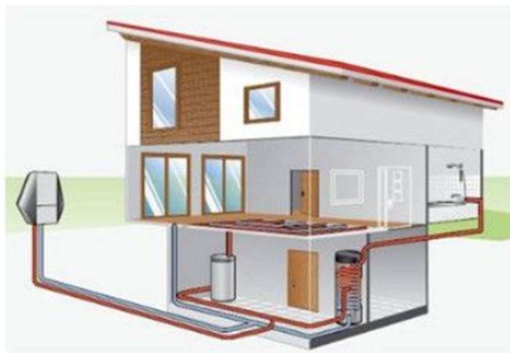
Obrázek 18: Tepelné čerpadlo vzduch/voda [19]
