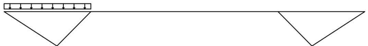
Obr. 66 Rovnoměrné zatížení od dopravy (UDL) var. 3
