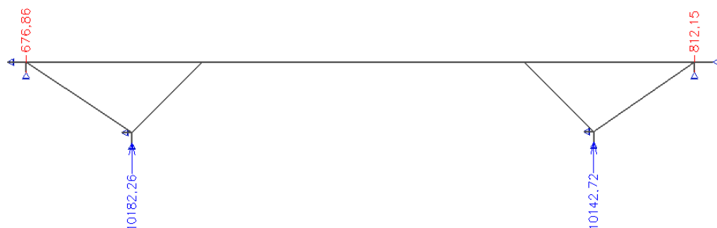
Obr. 210 Svislé reakce od vlastní tíhy – ocelové pruty
