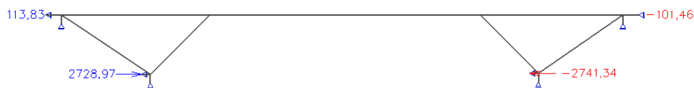
Obr. 209 Vodorovné reakce od vlastní tíhy – ocelové pruty
