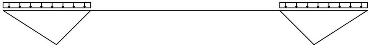
Obr. 64 Rovnoměrné zatížení od dopravy (UDL) var. 1
