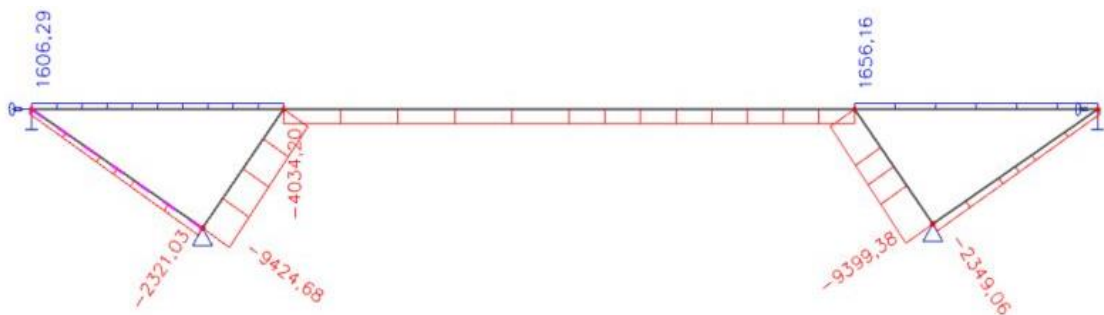
Obr. 84 Normálové síly od zatížení vlastní tíhou
