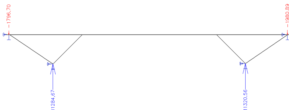
Obr. 178 Svislé reakce R_z od ZS1 – varianta s upravenou tuhostí ve směru osy x
