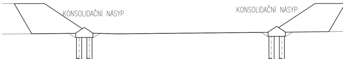
Obr. 201 Třetí fáze výstavby
