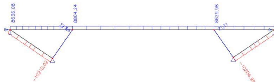
Obr. 89 Normálová síla od zatížení rovnoměrnou teplotou - 35 °C
