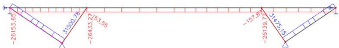
Obr. 85 Normálové síly od zatížení rovnoměrnou teplotou + 32 °C
