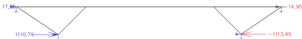
Obr. 179 Vodorovné reakce R_x od ZS1 – varianta s upravenou tuhostí ve směru osy x
