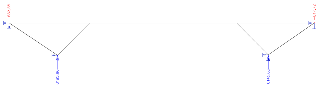
Obr. 208 Svislé reakce od vlastní tíhy – pružné podpory 7
