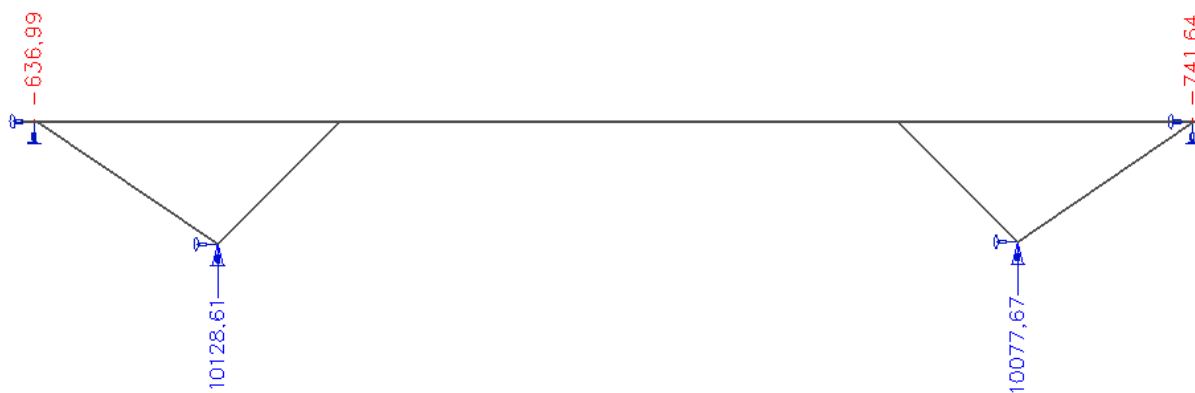
Obr. 182 Svislé reakce Rz od ZS1 – varianta s finální úpravou podpor
