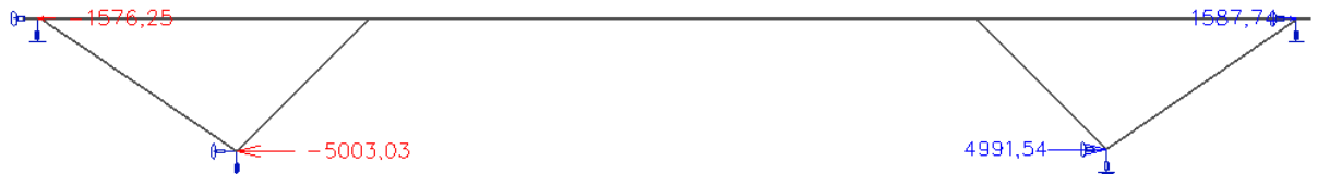
Obr. 184 Vodorovné reakce Rx od zatížení teplotou, která představuje účinky předpětí příčli
