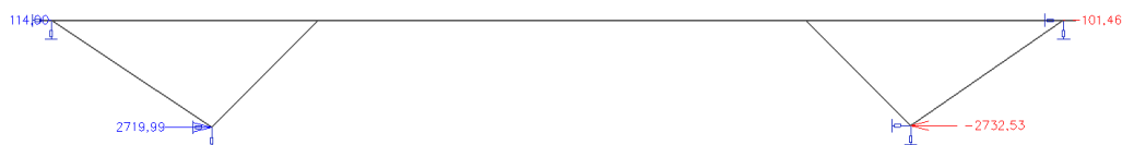
Obr. 207 Vodorovné reakce od vlastní tíhy – pružné podpory 7
