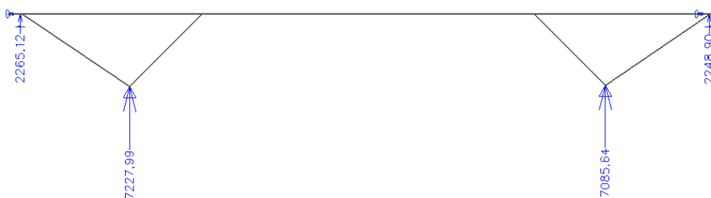
Obr. 176 Svislé reakce R_z od ZS1 – varianta s pevným kloubem
