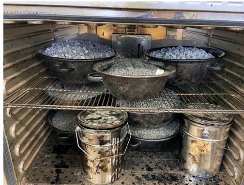
Obr. 15 Navážené frakce kameniva spolu s pojivem v sušárně [27]
