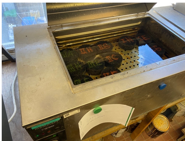
Obr. 24 Tělesa temperující se po dobu 68-72 hodin [27]
