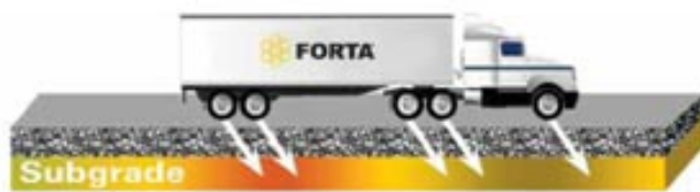
Obr. 5 Roznos sil při brždění na nevyztužené směsi [8]
