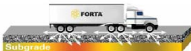
Obr. 6 Roznos sil při brždění na vyztužené směsi s 3D rozptýlenou výztuží (trojrozměrné rozložení sil) [8]
