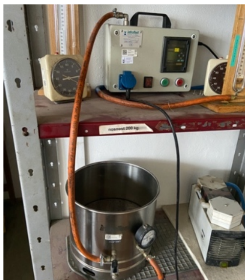
Obr. 20 Zařízení sloužící k odsání vzduchu z pyknometru [27]
