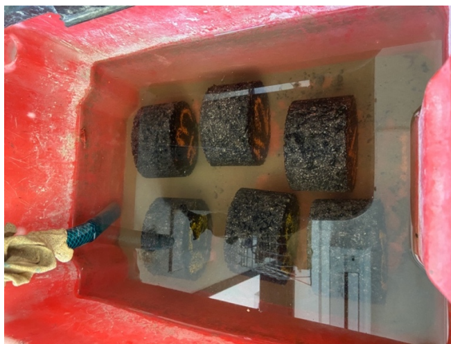
Obr. 22 Tělesa sytící se vodou [27]
