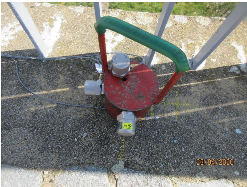
Obr. 015 Pohled na závaží s induktivními snímači zrychlení ve 3 na sebe kolmých směrech
