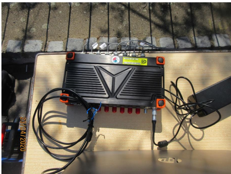
Obr. 017 Kalibrovaná sběrnice dat z inдуктивních snímačů zrychlení napojená na notebook se softwarem potřebným k vyhodnocování získaných údajů
