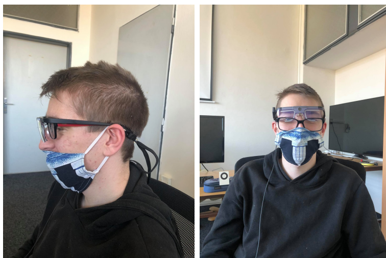
(a) Nasazení eye-tracking brýlí přes dioptrické brýle (b) Nasazení dioptrických brýlí přes eye-tracking brýle
