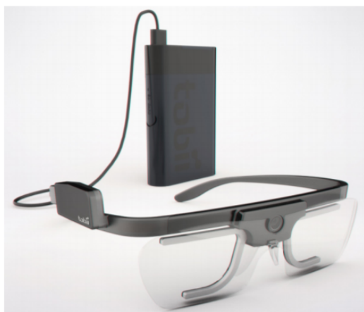
Obrázek 12: Zapojení brýlí a nahrávací jednotky
