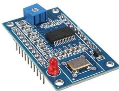
Obr. 8: Arduino generátor signálu [11]
