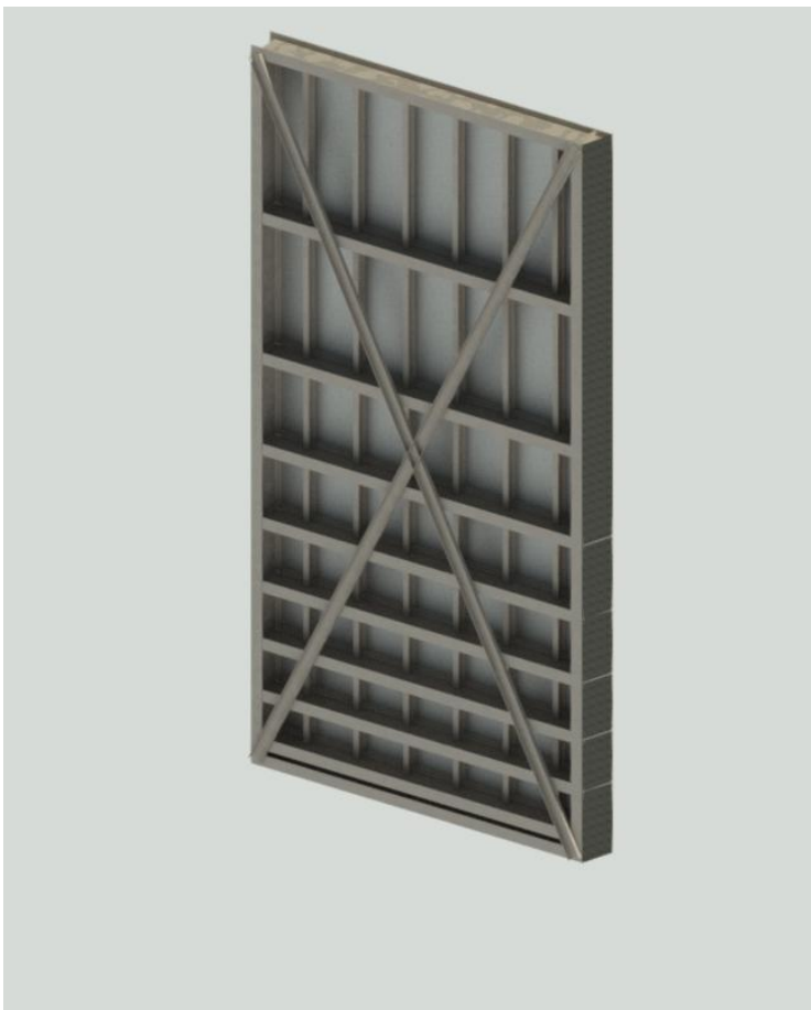
Obrázek 4: Vyrenderovaný obrázek z programu Revit, vrátěň dolního ohlaví.
