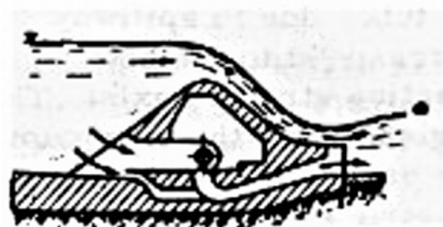
Obrázek 20 - Schéma ejekčního účinku – kombinace (9)
