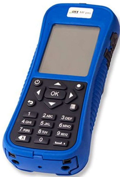
Obrázek 11 - Ovládací jednotka OTT MF pro [3]
