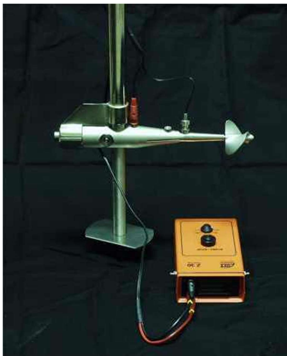
Obrázek 7 - Hydrometrická vrtule OTT C2 [1]
