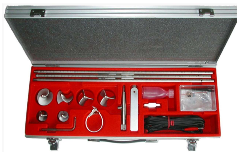
Obrázek 5 - Sada na měření hydrometrickou vrtulí SEBA [5]
