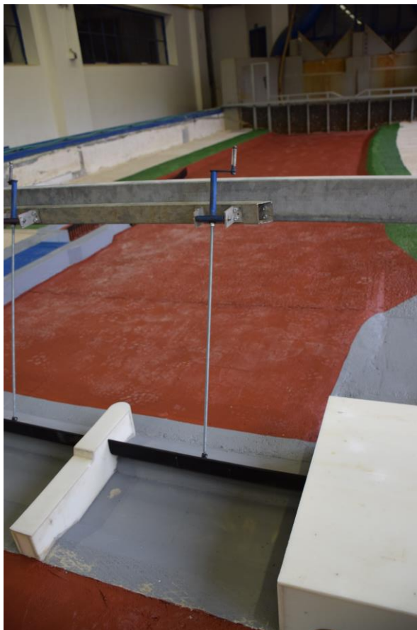
Obrázek 15: Manipulace s jezovými klapkami pomocí táhla
