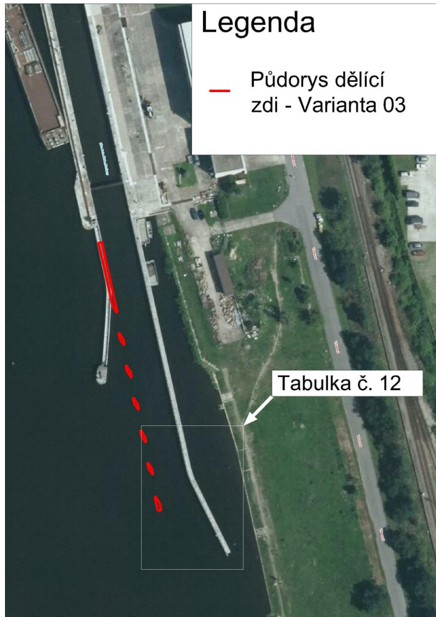
Obrázek 28: Půdorysné řešení dělicí zdi – varianta 03
