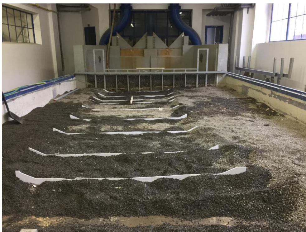
Obrázek 7: Osazení příčných profilů
