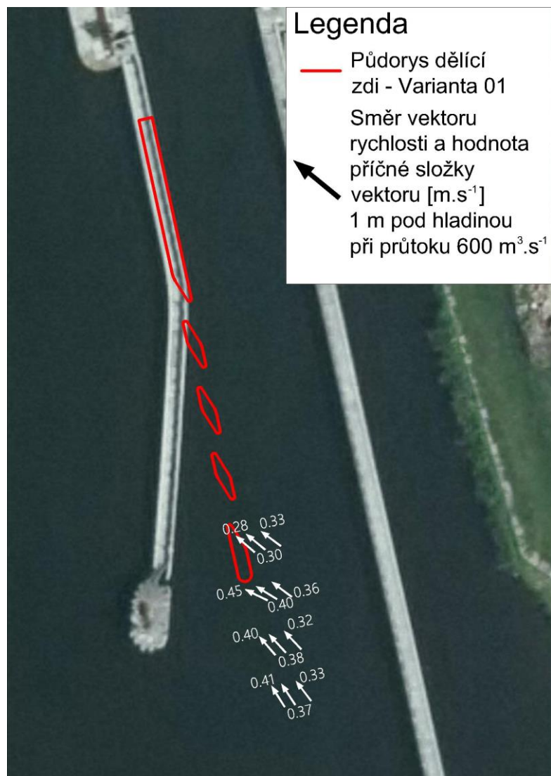
Obrázek 21: Poměry příčných složek rychlostí v hloubce 1 m při průtoku 600 \text{ m}^3 \cdot \text{s}^{-1} u varianty 01
