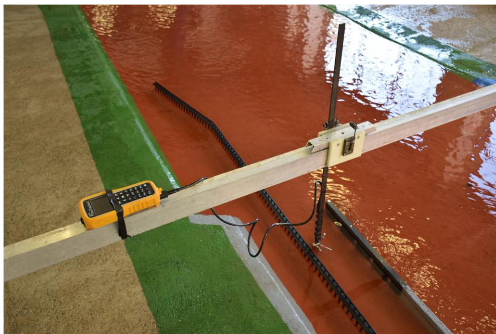
Obrázek 16: Měření příčné složky rychlosti hydrometrickým přístrojem FlowTracek2
