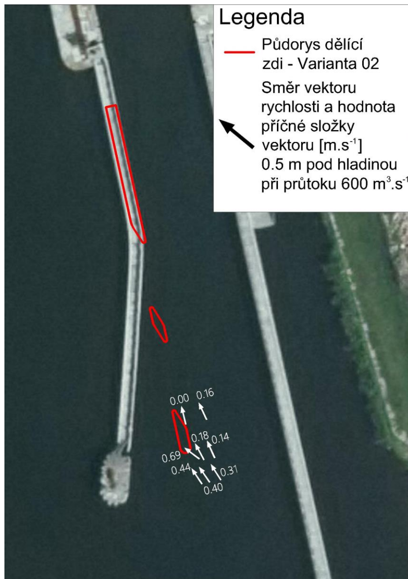
Obrázek 24: Poměry příčných složek rychlostí v hloubce 0,5 m při průtoku 600 m 3 .s -1 u varianty 02
